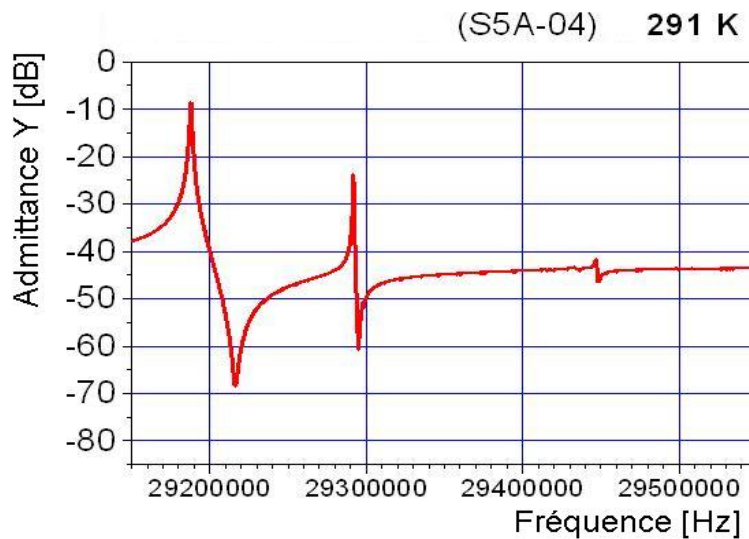
Figure 4.27. Spectre du résonateur QT no. S5A-04 enregistré à 291 K.
