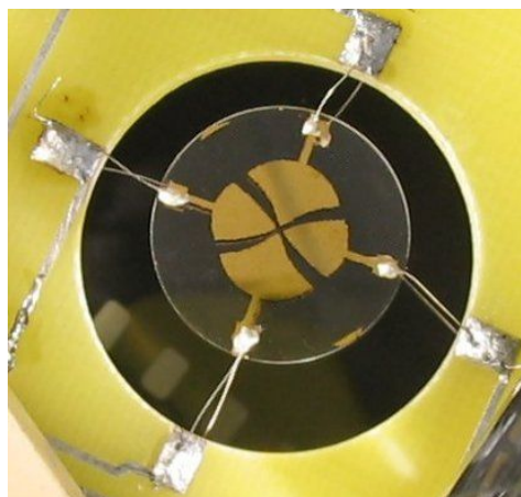
Figure 3.98. La forme finale du résonateur avec les contacts électriques collés, dans le montage de tests électriques et de topographies par diffraction de rayons X.
