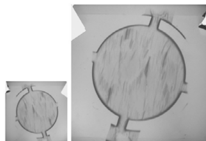
Figure 3.38. Résonateur multi-électrodes conçu pour opérer sur les modes anharmoniques (3,0,2) et (3,2,0)
