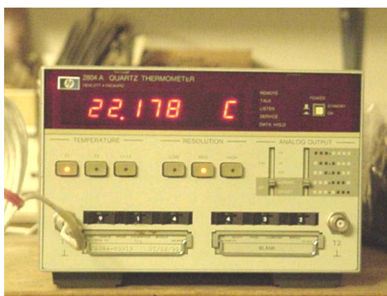
Figure 4.1. Thermomètre numérique modèle HP Agilent 2804A
