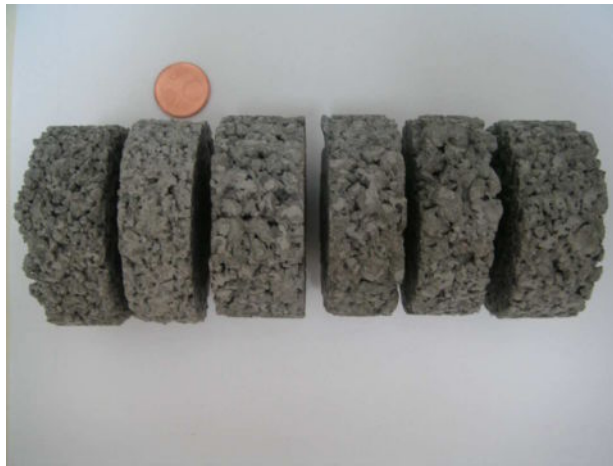
Figure 5.10 – Découpe de l'échantillon en 6 tronçons cylindriques
