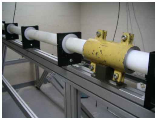
Figure F.1 – Mise en position du moule contenant l'échantillon, lors d'un essai SHPB sur le béton frais
