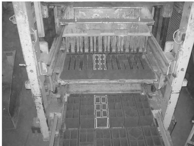
Figure 1.12 – Photo d'une presse vibrante lors de la sortie des produits
