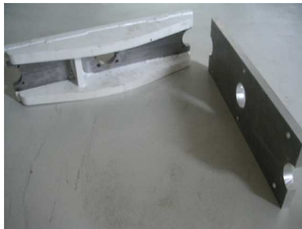
Figure 4.1 – Photo des deux plaques-supports utilisées : en acier et en aluminium
