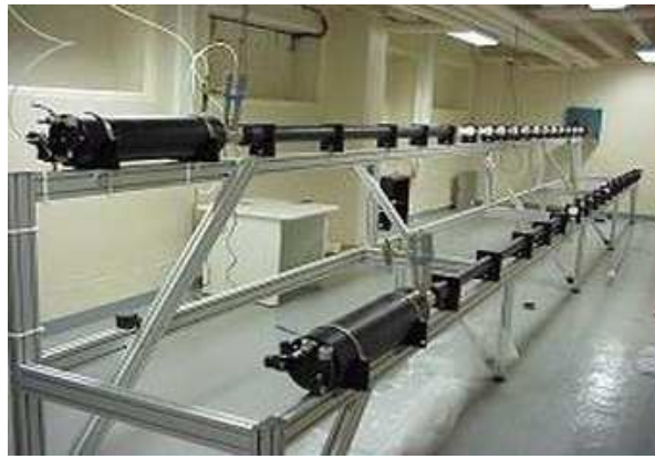
Figure M.2 – Photographie de deux systèmes de barres de Hopkinson (LMT Cachan)
