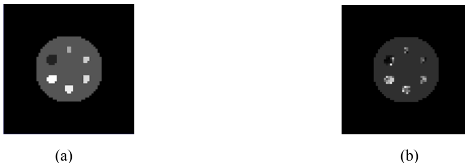
Figure V-34. Coupe reconstruite avec (a) la méthode des régions fonctionnelles, (b) la méthode des régions hybrides
