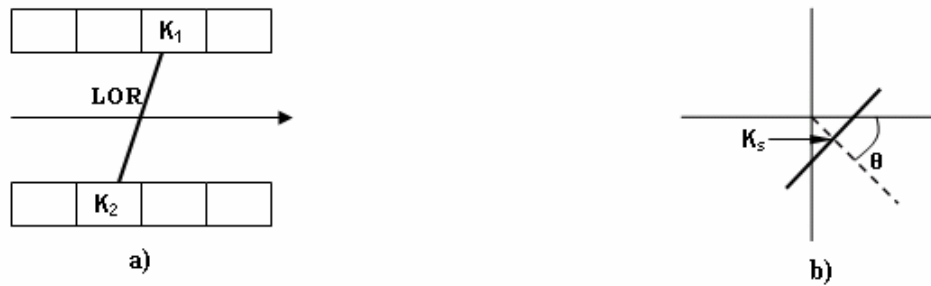
Figure IV-6. a) coordonnées d'une LOR dans le plan axial, b) coordonnées d'une LOR dans le plan transaxial.
