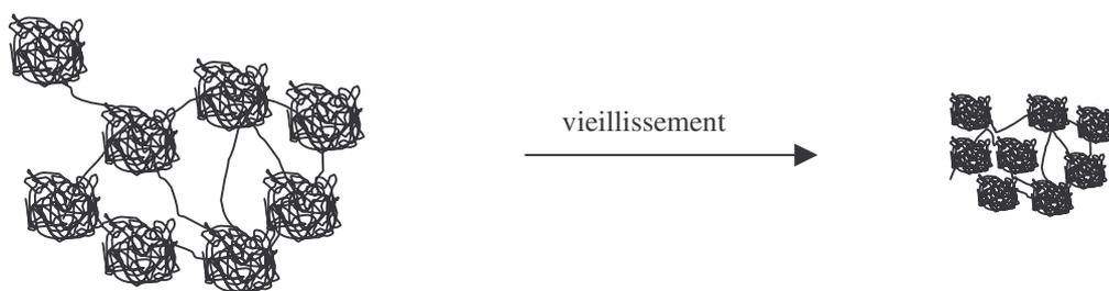
Figure I.23 : Gels obtenus à partir de tétralcoxydes de silicium par catalyse basique.
