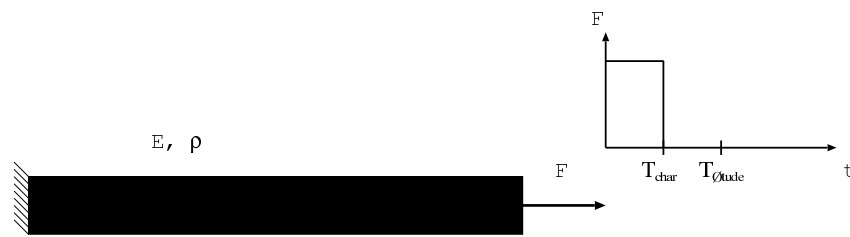
Figure 1.16: Exemple numérique : créneau
