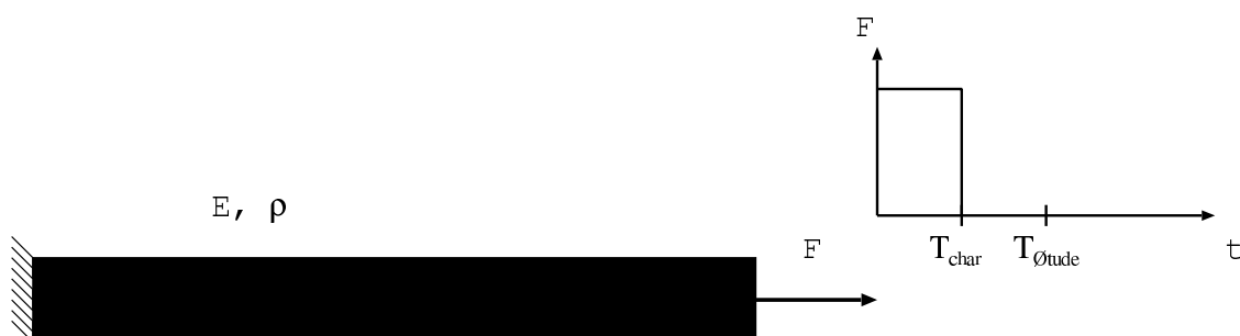
Figure 1.20: Exemple numérique : créneau
