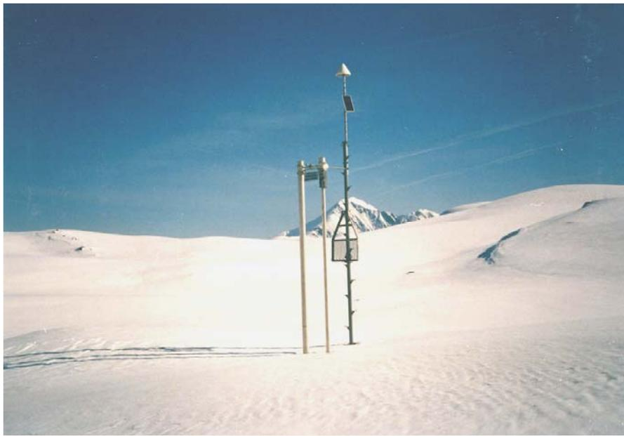
Figure II-3 Télé nivomètre EDF situé au Lac Noir
