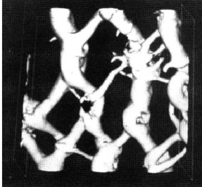
FIG. 2.18 – Exemple de visualisation tridimensionnelle du champ de basse pression issu d'une simulation aux grandes échelles d'une couche de mélange plane (Métais [91]).
