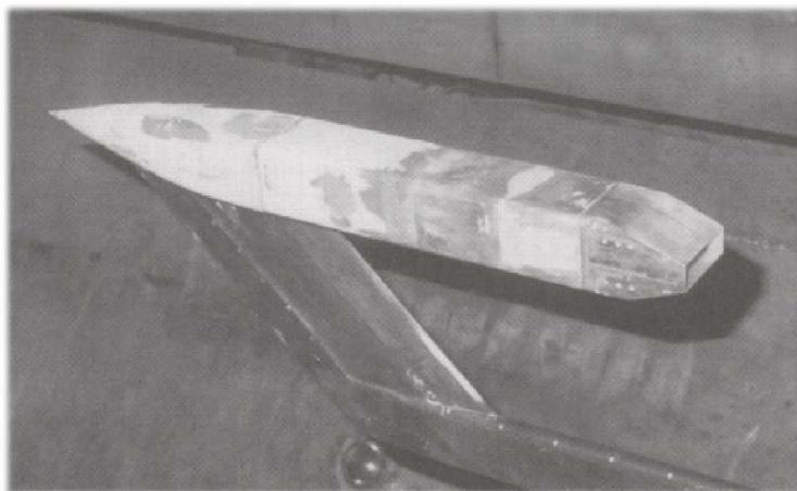
FIG. 6.16 – Montage en veine de l'arrière-corps AGARD.
