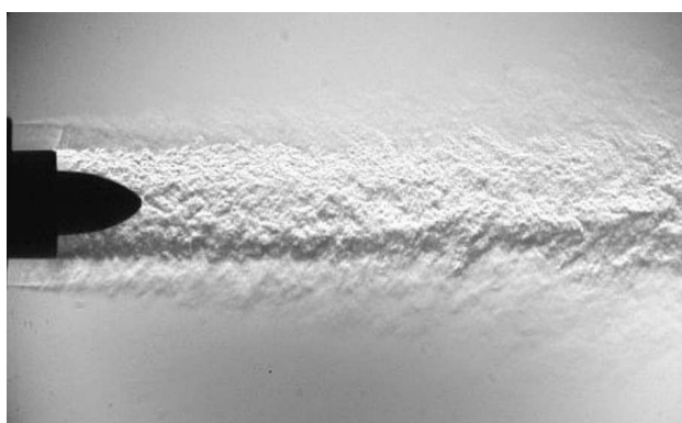
FIG. 1.7 – Strioscopie expérimentale d’un écoulement d’arrière-corps CFM 56 en régime subsonique [59].
