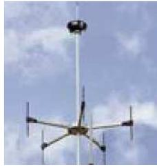
FIG. 1.4 – Réseau circulaire de 5 dipôles
