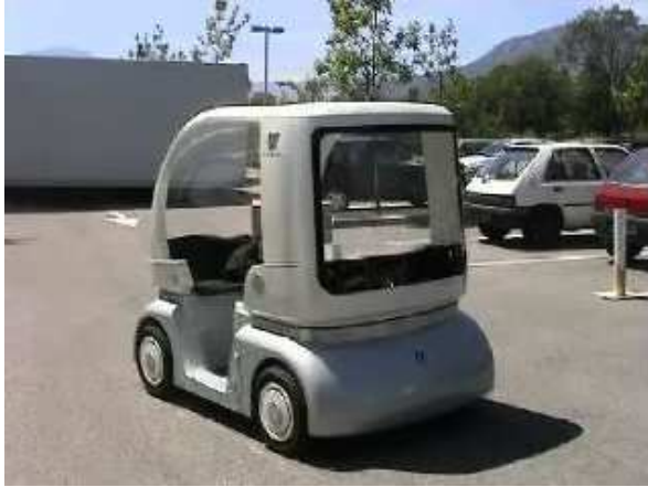
FIG. 3.2 – Le robot Cycab, un robot de type voiture
