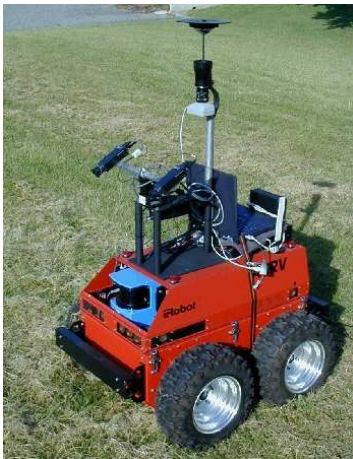
FIG. 3.13 – Le robot Dala, un robot de type unicycle
