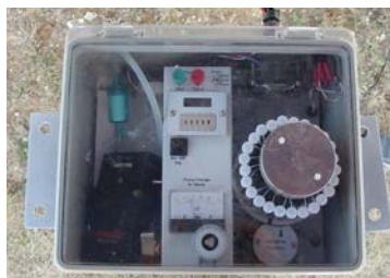
Figure IV-4 : Préleveur séquentiel de COV (STS 25)
