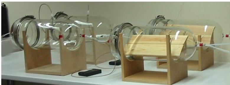
Figure II-5 : Chambres d'essai d'émission
