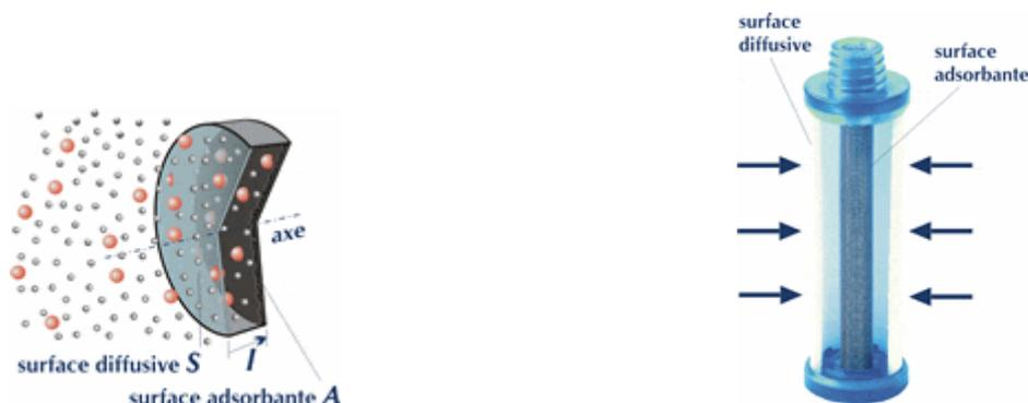
Sous le gradient de concentration  $dC/dl$ , les molécules gazeuses traversent la surface diffusive  $S$  et vont se piéger sur la surface adsorbante  $A$  selon la loi de Fick :
