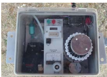
Figure IV-4 : Préleveur séquentiel de COV (STS 25)
