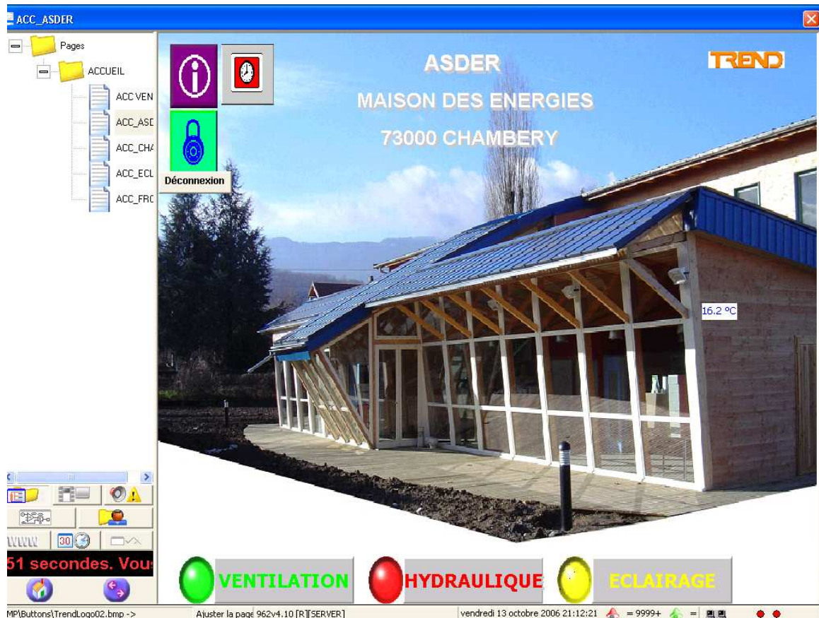
Figure 4. 9 : Interface graphique permettant de piloter l'installation de la maison des énergies.
