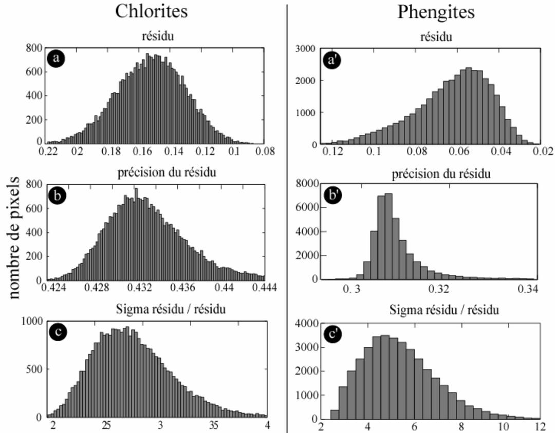
**Figure 15:** (a-a') Histogramme du résidu des chlorites et des phengites. On observe une déviation de la valeur moyenne de l'histogramme du zéro théorique. (b-b') Histogramme des valeurs de la précision sur le résidu. (c-c') Histogramme des valeurs de la précision du résidu divisées par les valeurs du résidu. Toutes les analyses dont le quotient était inférieur à 1 sont éliminées.
