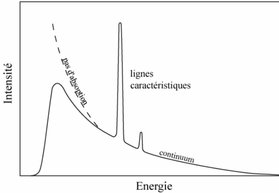
**Figure 11:** *spectre de rayons X montrant des pics élémentaires caractéristiques superposés au spectre RX continu (ou continuum) produit par les électrons incidents impliqués dans les collisions inélastiques avec les nucléus atomiques. Le spectre diminue rapidement à basse énergie à cause de l'absorption dans la fenêtre des détecteurs. Le continuum est le principal effet responsable du bruit de fond d'une analyse (d'après Reed, 1996).*
