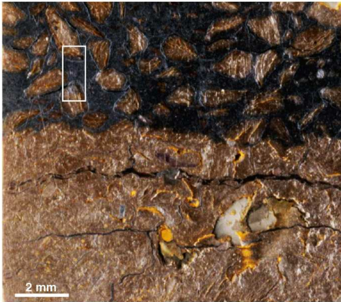
Figure 61 : numérisation de la section mince provenant de l'échantillon analogue aux argiles de Stripa. Le rectangle blanc correspond à la zone sur laquelle des images RX ont été acquises.
