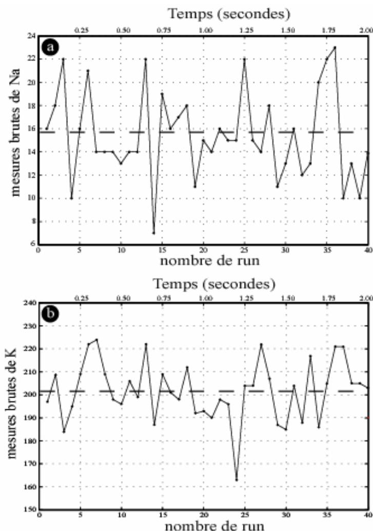
**Figure 8:** (a) évolution temporelle de la mesure de Na. (b) évolution temporelle de la mesure de K. Ces mesures sont peu précises compte tenu du taux de comptage bas, mais il n'y a pas d'évidence d'une augmentation ou d'une diminution du signal au cours du temps.
