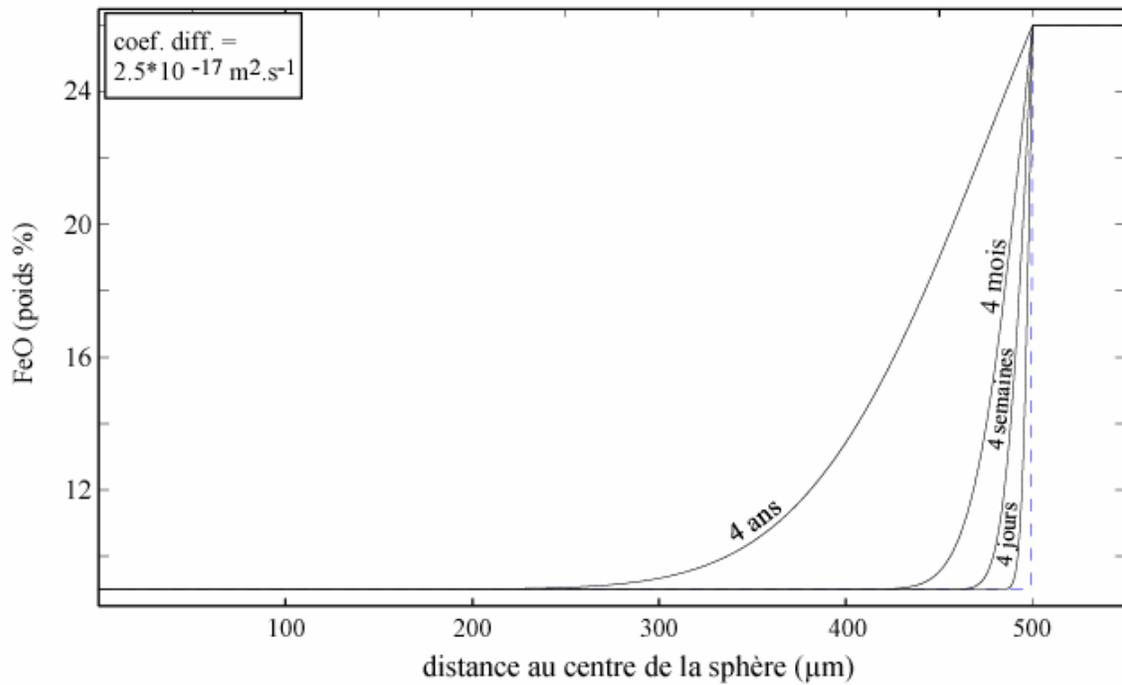
**Figure 69 :** évolution sur 4 jours, 4 semaines, 4 mois et 4 ans d'un profil de diffusion dans deux sphères de rayon respectif de 150 et 500  $\mu\text{m}$ . Ces profils sont calculés à partir de la loi de la diffusion pour un coefficient de diffusion de  $2.5 \cdot 10^{-17} \text{ m}^2 \cdot \text{s}^{-1}$ .
