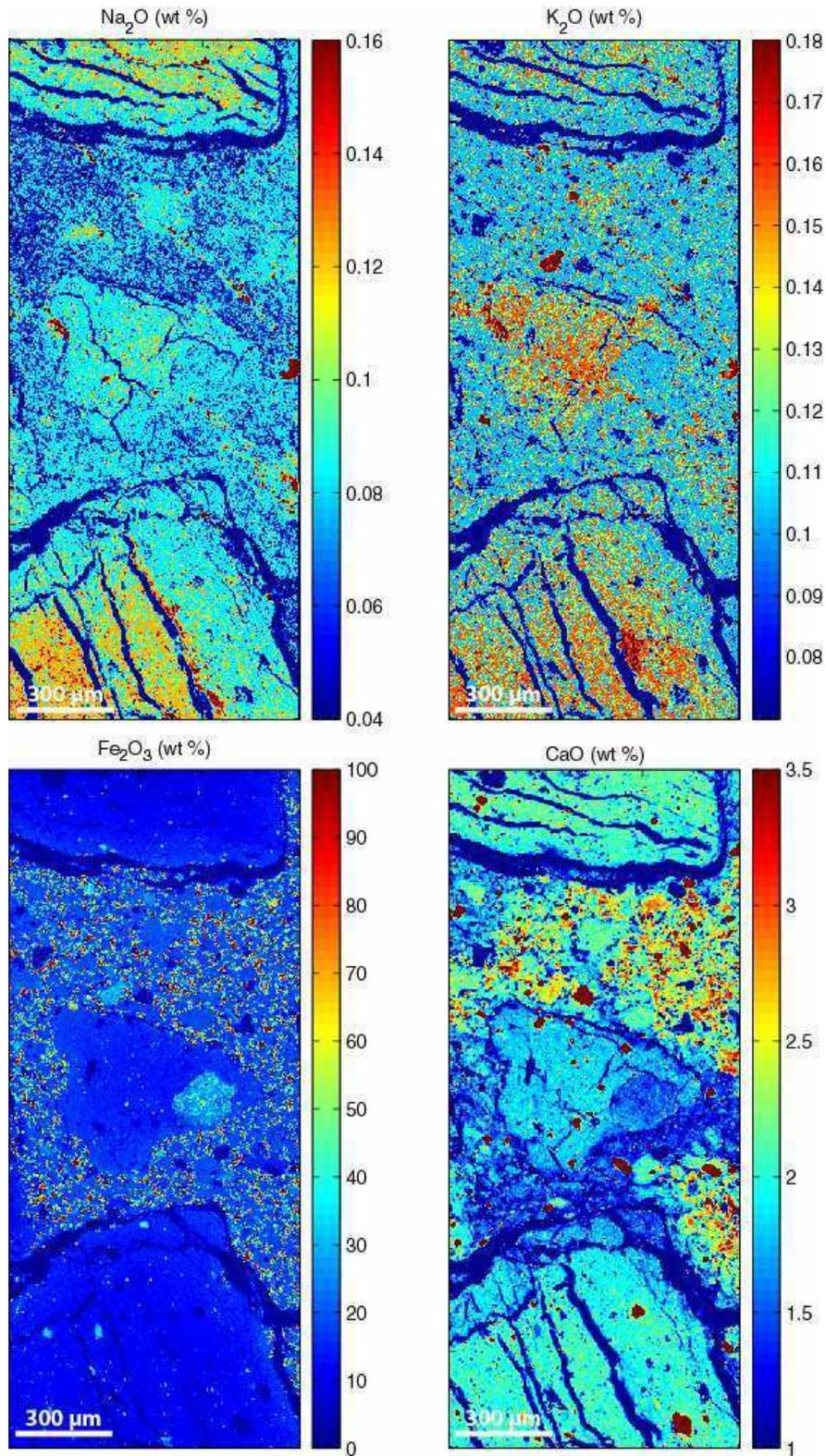
**Figure 64:** images des oxydes  $\text{Na}_2\text{O}$ ,  $\text{K}_2\text{O}$ ,  $\text{CaO}$  (en poids pourcents) de l'échantillon provenant de l'expérience analogique du CEA. L'image du  $\text{Fe}_2\text{O}_3$  met ici en évidence les sphérules de fer métal.
