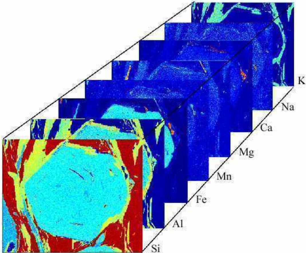
**Figure 4:** matrice 3D contenant 8 images RX brutes (=signal mesuré) de Si, Al, Fe, Mn, Mg, Ca, Na et K (échantillon contenant un grenat au centre de l'image, des chlorites, des phengites et du quartz). La taille de la 3ème dimension de la matrice correspond au nombre d'éléments analysés.
