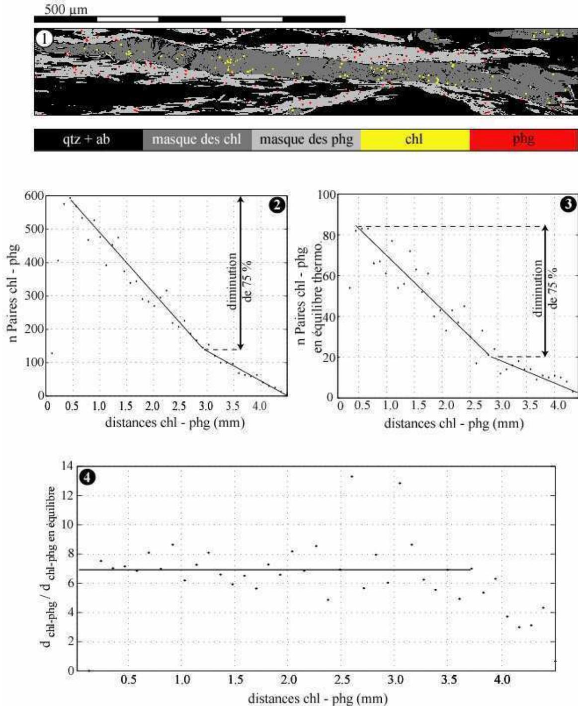
**Figure 33 :** (1) représentation des pixels de chl et de phg sélectionnés pour le calcul automatique des équilibres thermodynamiques. (2) Maximums des barres de l'histogramme des distances entre toutes les paires chl- phg de l'image. (3) Maximums des barres de l'histogramme des distances entre les paires chl- phg en équilibre thermodynamique. (4) Rapport des maximums des barres des histogrammes (2) et (3).
