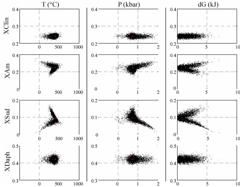
**Figure 21:** résultats des tests de propagation d'erreur par la méthode de Monte Carlo sur les chlorites exprimés dans des diagrammes « Pôles purs vs T, P et  $\Sigma\Delta G^2$  ». T, P et  $\Sigma\Delta G^2$  sont contrôlés essentiellement par la fraction de sudoïte et d'amésite.
