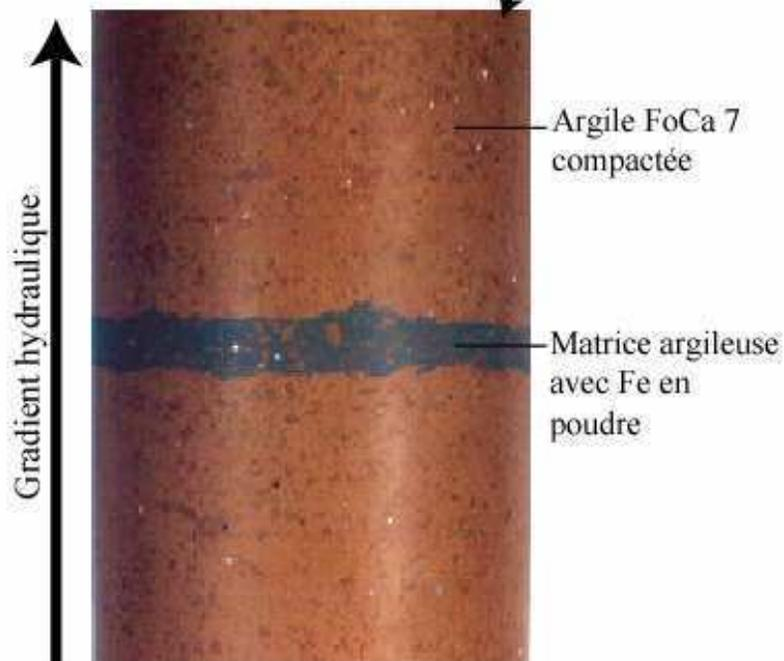
**Figure 60 :** dispositif expérimental soumettant un échantillon d'argiles compactées à la percolation forcée de fluides pendant 1 ans. L'échantillon subit un gradient hydraulique de 100 bars. Sa température est homogène et maintenue à 25°C pendant toute la durée de l'expérience. Il est ensuite placé dans un milieu confiné toujours à 25°C pendant 3 ans.
