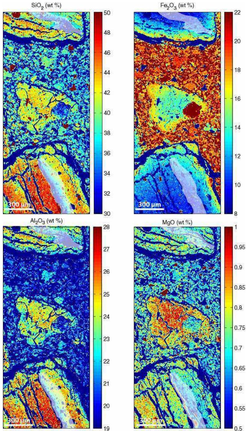
**Figure 63:** images des oxydes  $\text{SiO}_2$ ,  $\text{Fe}_2\text{O}_3$ ,  $\text{Al}_2\text{O}_3$  et  $\text{MgO}$  (en poids pourcents) de l'échantillon provenant de l'expérience analogique du CEA équivalente à celle de Stripa. 3 nodules d'argiles sont visibles en haut, au centre et en bas de l'image. Les zones rouges riches en  $\text{Fe}_2\text{O}_3$  correspondent à la matrice argileuse. Les zones dont l'état de surface est mauvais sont recouvertes d'un film grisé transparent.
