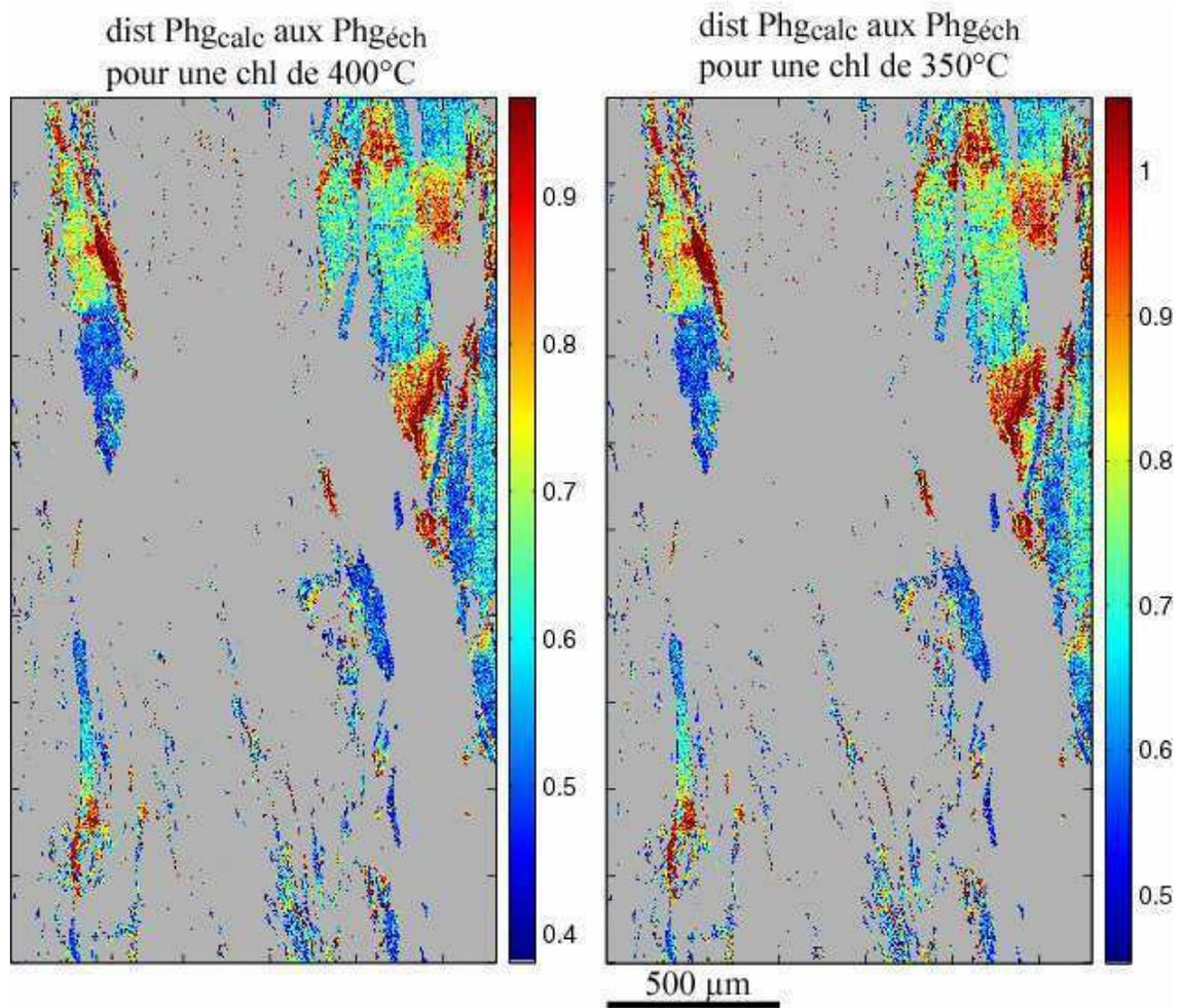
**Figure 55 :** distances adimensionnées entre deux Phg optimisées et les Phg de l'échantillon dans l'espace chimique XM<sub>s</sub>, XP<sub>rl</sub>, XC<sub>el</sub>, XP<sub>g</sub>, XP<sub>hl</sub> et XM<sub>g</sub>. Ces deux Phg ont été optimisées pour des Chl de 400 et 350 °C. Les Phg les plus proches de l'équilibre thermodynamique avec ces Chl de compositions chimiques significativement différentes sont quasiment les mêmes.
