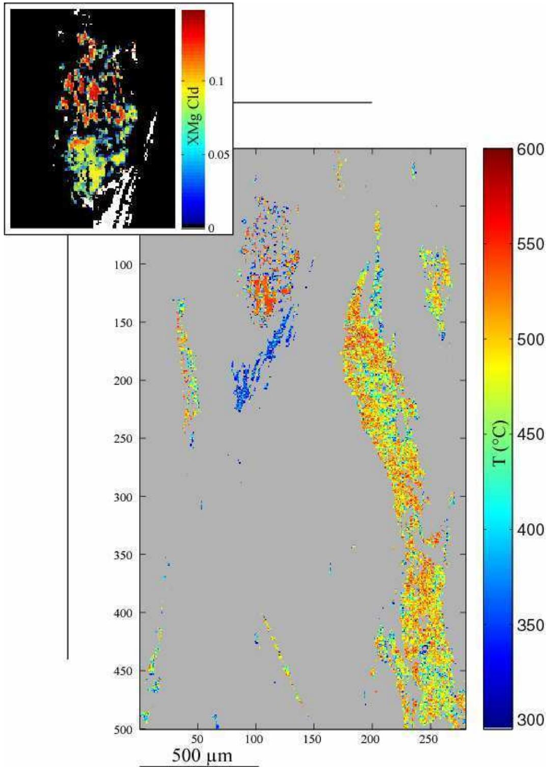
**Figure 53 :** carte de température de formation des chlorites et des chloritoïdes. La température de chaque pixel est estimée par interpolation linéaire à partir des résultats P-T issus des calculs automatiques de multi-équilibre Chl-Cld. Seuls les Cld présentant un XMg < à 0.1 s'équilibrent avec les Chl, les Cld possédant un XMg élevé ne sont donc pas représentés sur la carte de T.
