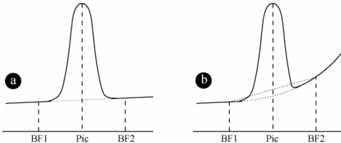
**Figure 12:** *bruit de fond calculé au niveau du pic de la raie d'émission en moyennant les intensités mesurées autour de la position du pic (BF1, BF2). (a) Lorsque le bruit de fond est linéaire, le résultat obtenu pour le bruit de fond sous le pic est correct. (b) Avec un bruit de fond incurvé, le résultat est par contre incorrect (d'après Reed, 1996).*
