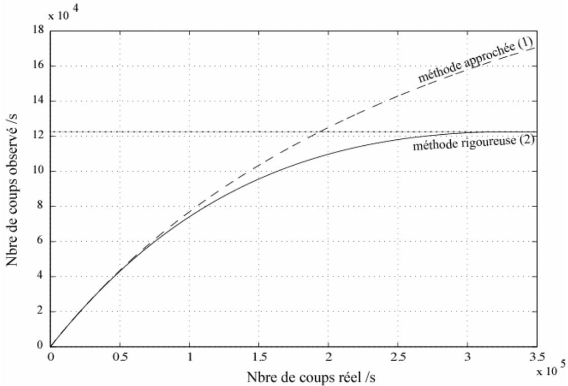
**Figure 10:** tracé de deux fonctions modélisant la relation entre le nombre de coups mesuré par un spectromètre et le nombre de coups réel le heurtant. Ces fonctions sont tracés pour un temps mort de récepteur de  $0.3 \mu s$ , valeur typique pour un spectromètre WDS. Fonction (1):  $I_r = I_m / (1 - t * I_m)$ ; fonction (2):  $I_m = I_r \cdot e(-I_r * t)$ ,  $I_m$  étant l'intensité mesurée, l'intensité réelle et  $t$  le temps mort du spectromètre.
