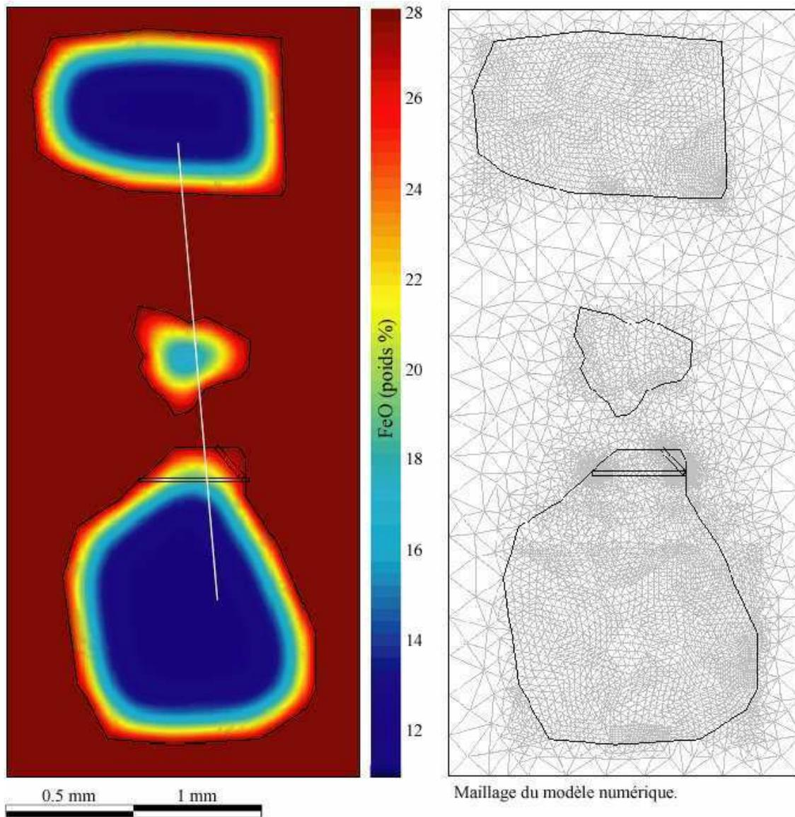
**Figure 70 :** modélisation numérique de la diffusion du fer depuis une matrice argileuse vers l'intérieur de nodules d'argiles. Cette image représente l'état du système après 4 années. A  $t_0$ , la concentration en  $Fe_2O_3$  était de 10 % dans l'ensemble des nodules. La concentration dans la matrice (32 %) reste fixe au court du temps. Le coefficient de diffusion estimé est de  $5 * 10^{-17} m^2.s^{-1}$ .
