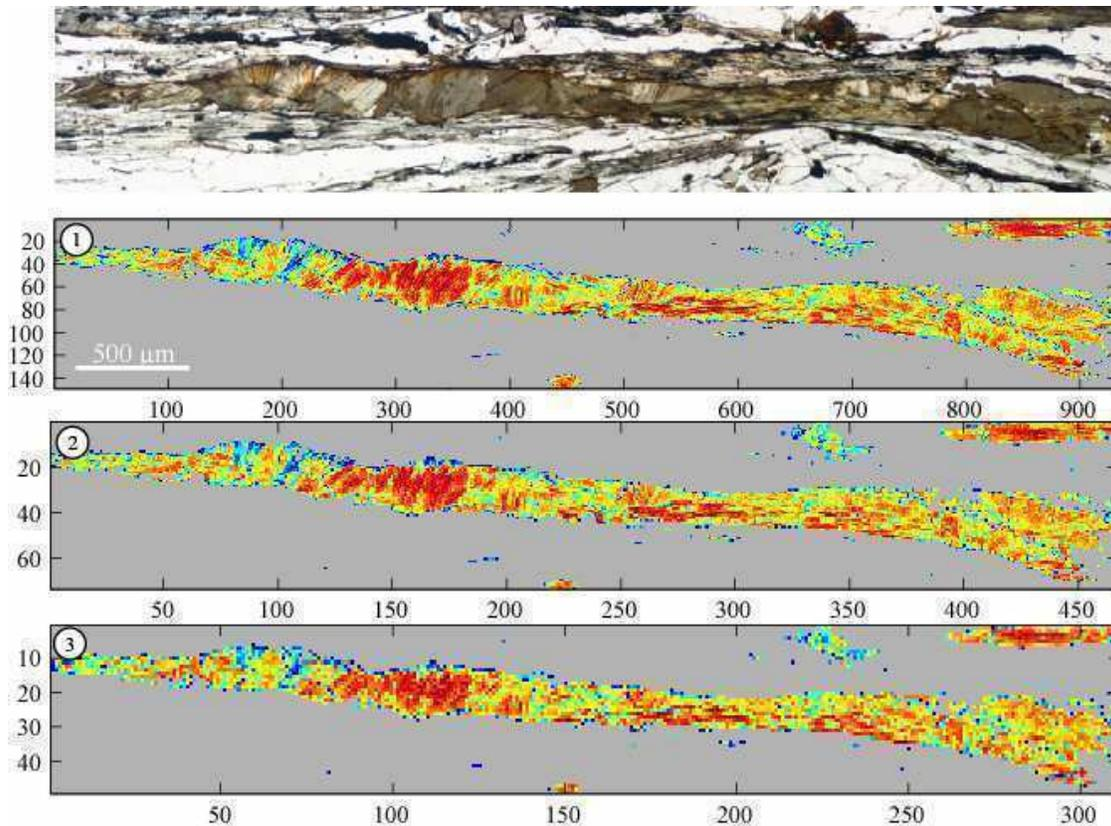
**Figure 6:** simulation de deux images brutes de Mg que l'on obtiendrait avec différentes résolutions. (1) est l'image originale non modifiée acquise avec un pas de mesure de  $5\mu\text{m}$ . (2) et (3) sont des images recréées à partir de la (1). 1 pixel sur 2 puis 1 pixel sur 3 ont été sélectionnés sur l'image (1) pour obtenir des cartes dont la résolution d'un pixel serait de 10 et  $15\mu\text{m}$  de côté.
