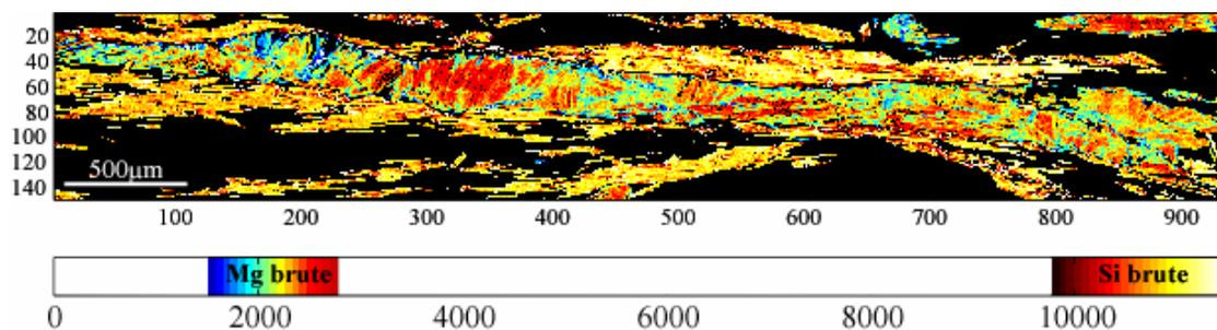
**Figure 7:** image RX brute (933\*147 pixels) composite du Mg dans les chlorites et de Si dans les phengites. Les deux échelles de couleur sont adaptées pour faire ressortir les variations chimiques de 2 phases sur une même image. Les variations chimiques mettent en évidence des structures très fines de l'ordre de la vingtaine de microns.
