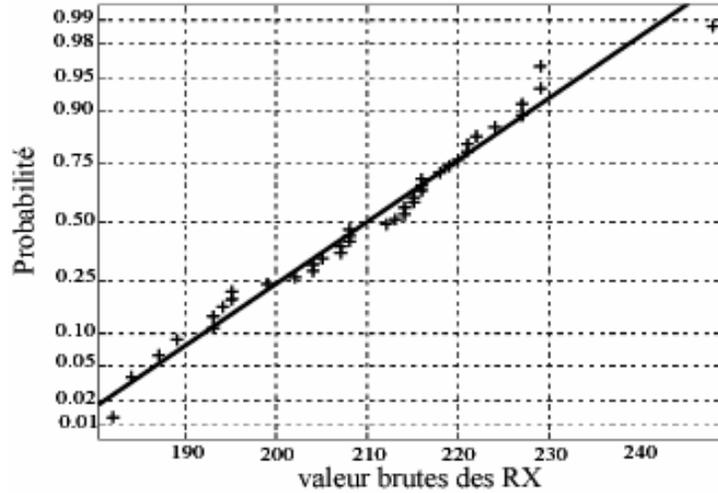
**Figure 9:** diagramme de probabilité de Poisson. Sur l'axe X sont reportés les valeurs des mesures brutes pour un même pixel au cours du temps et sur l'axe Y les valeurs de probabilité théoriques (d'après la loi de Poisson) correspondant aux données. Le fait que les points s'alignent le long de la ligne noire dans ce diagramme implique que nous sommes bien dans une statistique de comptage poissonnienne.
