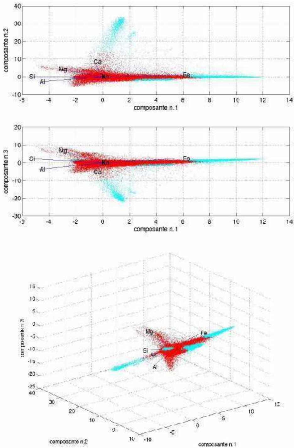
**Figure 67:** résultats des analyses en composantes principales en 2D et 3D sur l'ensemble des pixels. En rouge sont représentées les analyses des pixels classés comme argiles, et en bleu le reste des pixels. Les axes élémentaires sont également représentés.
