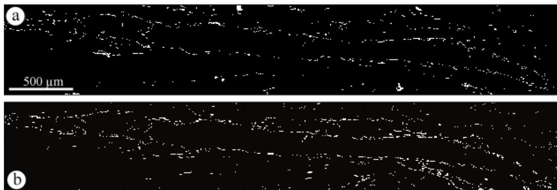
**Figure 16:** image des analyses de chlorites (a) et de phengites (b) éliminées par le programme de filtrage. Ces éliminations sont dues : à un bruit analytique excessif, des minéraux "accessoires" non pris en compte, ou encore des analyses correspondant à un mélange de 2 phases lorsque le faisceau d'analyse frappe la limite de 2 minéraux. Ces analyses filtrées mettent en évidence essentiellement la limite de la queue de cristallisation de chlorite bordée en majorité par des phengites.
