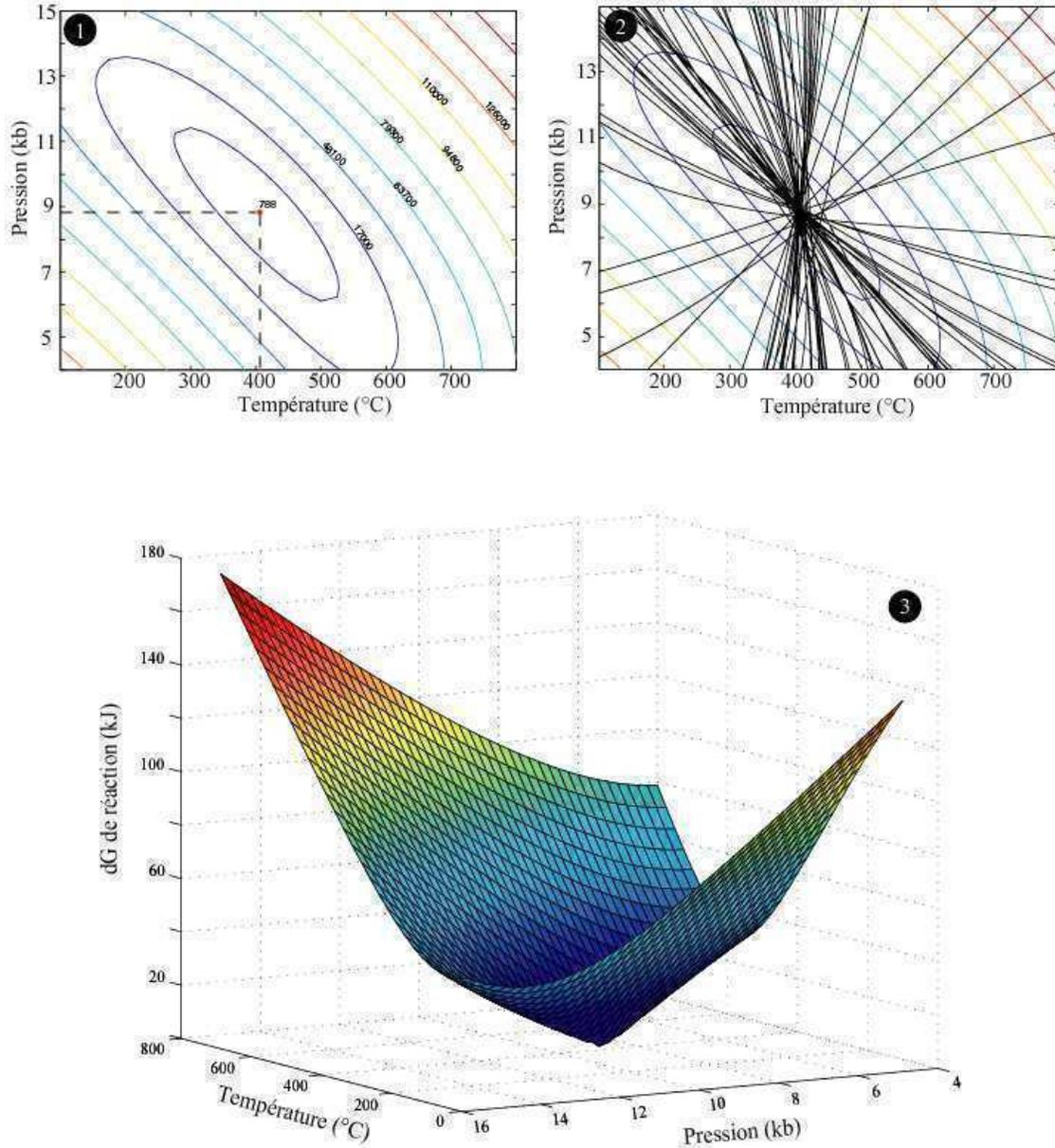
**Figure 26:** (1) représentation des courbes de niveau de la fonction  $\Sigma\Delta G^2$  dans un diagramme P-T. Le  $\Sigma\Delta G^2$  de réaction est calculé pour un couple Chl - Phg en équilibre à 8.8 kbar 406 °C (matérialisé par un astérisque rouge). Cette fonction montre un seul minimum. (2) Projection sur le graphique précédent des réactions d'équilibre Chl - Phg se croisant toutes à proximité du minimum de la fonction. (3) représentation 3D de la fonction  $\Delta G$ .
