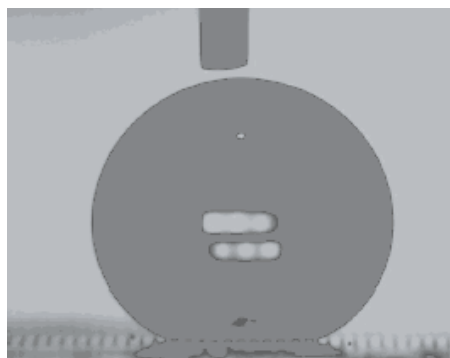
Fig. V.3: Photo d'une goutte posée sur une surface hydrophobe structurée à l'échelle micrométrique ; on observe une interface composite (d'après [50]).
