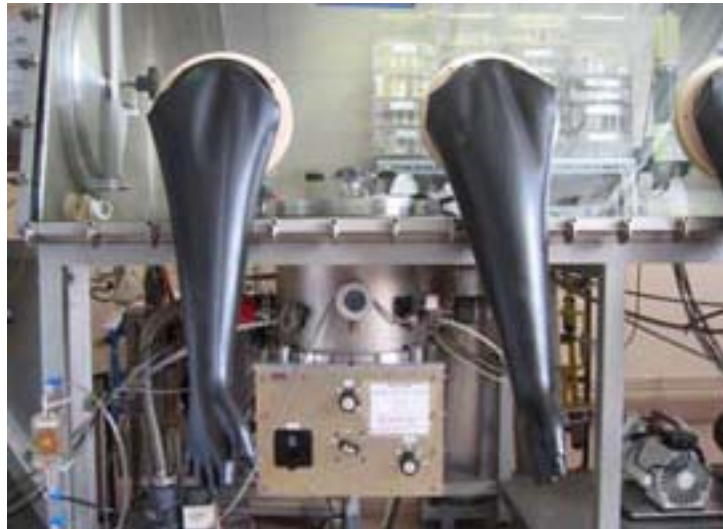
Figure II.7 : Enceinte de pulvérisation Plassys reliée à une boîte à gants
