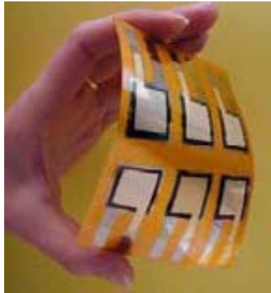
Figure I.4 : Six microbatteries déposées sur un substrat souple
