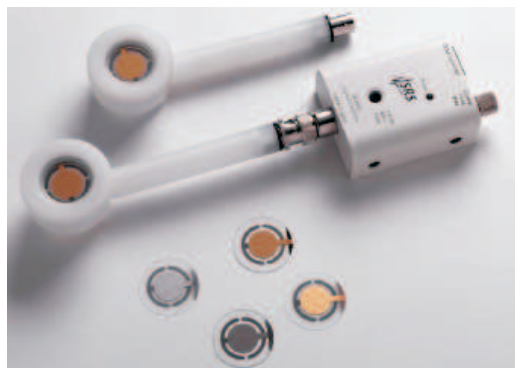
FIG. 3.2 – Microbalance à quartz : le quartz dans son support, adapté pour l'utilisation en électrochimie, connecté à l'oscillateur.
