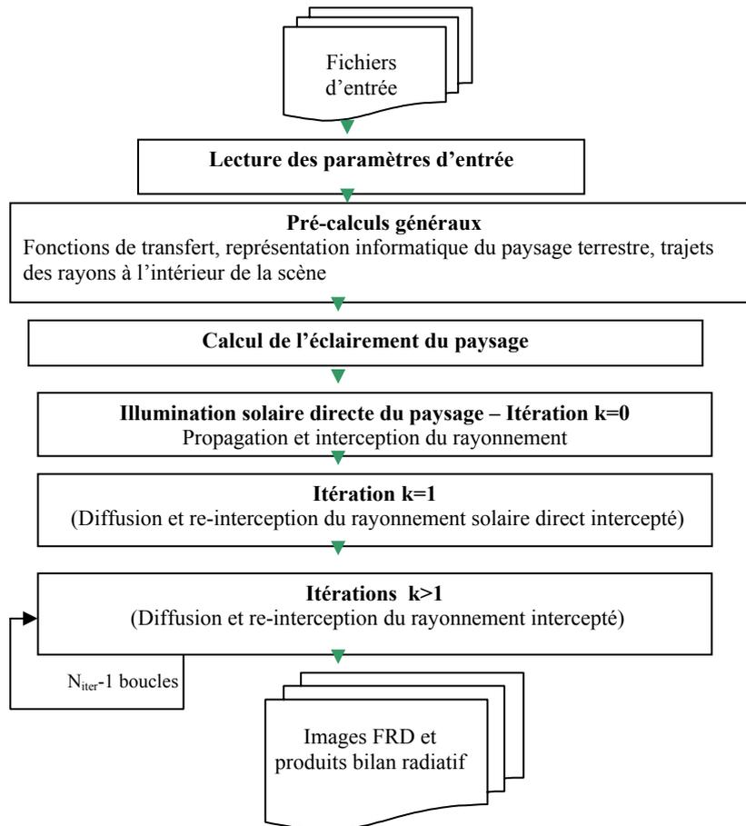
Figure II-5: Principales étapes de simulation du modèle DART.
