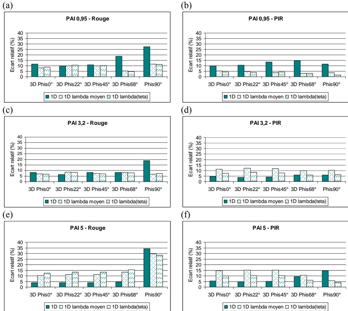
Figure IV-15: Ecart relatif entre la FDRB dans le **plan principal** pour les simulations en 3D et la FDRB pour les simulations en 1D et 1D agrégé pour les trois stades phénologiques. Simulations réalisées avec un sol **limoneux lambertien** et un  $\theta_s$  de  $45^\circ$ .
