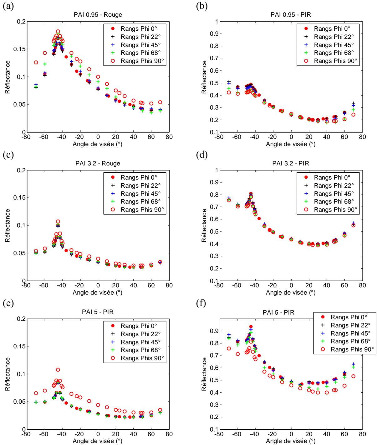
Figure A6-3: FDRB 3D dans le **plan principal** simulées pour un sol **limoneux anisotrope** pour les trois stades phénologiques et dans deux bandes spectrales : proche infrarouge (790-890 nm) et rouge (610-680nm).  $\theta_s = 45^\circ$ , tous les  $\phi_s$  sont représentés.
