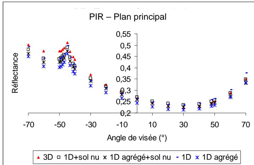
Figure V-7: FDRB simulées dans le proche infrarouge dans le plan principal pour différents degrés d'hétérogénéité. Les angles zénithal et azimutal solaires sont de  $45^\circ$ .
