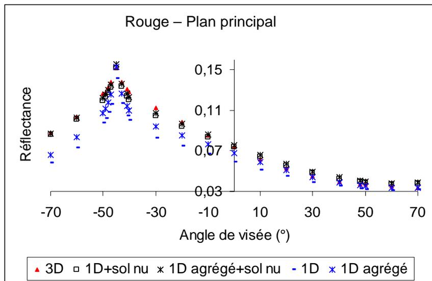
Figure V-5: FDRB simulées dans le rouge dans le plan principal pour les différents degrés d'hétérogénéité pris en compte. Les angles zénithal et azimutal solaires sont de 45°.
