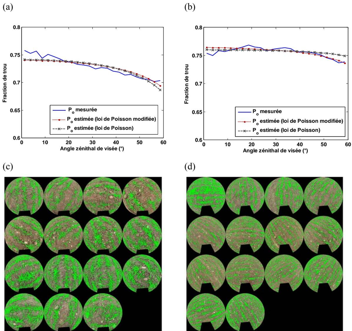
Figure III-1 : Fraction de trou mesurée sur le couvert de blé le 4 mars 2005, (a) photographies acquises à 30cm de la canopée et (b) à 60cm. Classification issue de CAN\_EYE, (c) photos à 30cm et (d) à 60cm ; les pixels classés en feuilles sont représentés en vert.
