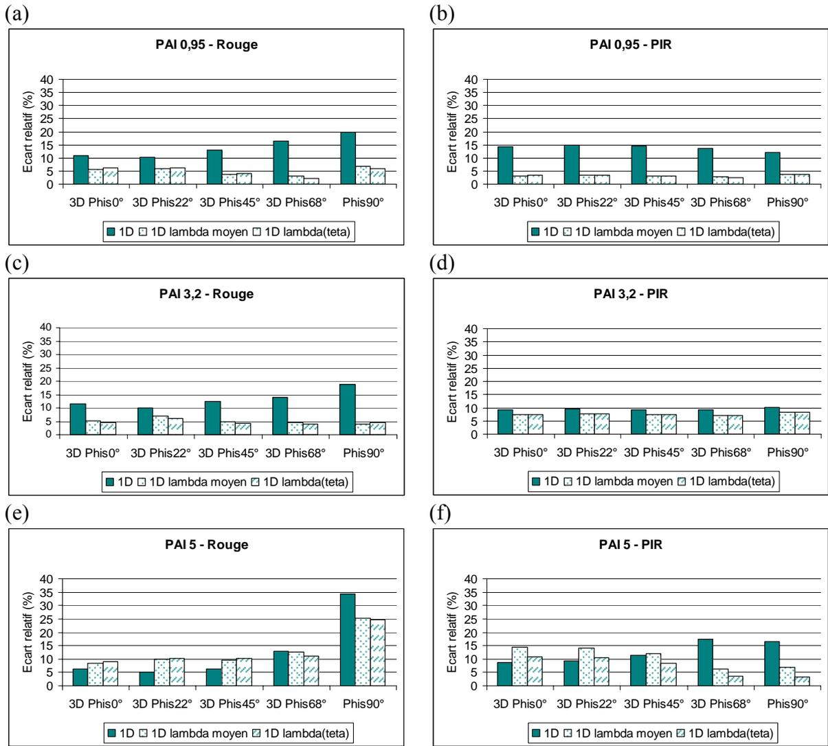
Figure A8-3: Ecart relatif entre la BRDF dans le **plan principal** pour les simulations en 3D les simulations en 1D et 1D agrégé pour les 3 stades phénologiques. Simulations réalisées avec un sol **limoneux lambertien** et un  $\theta_s$  de  $20^\circ$ .
