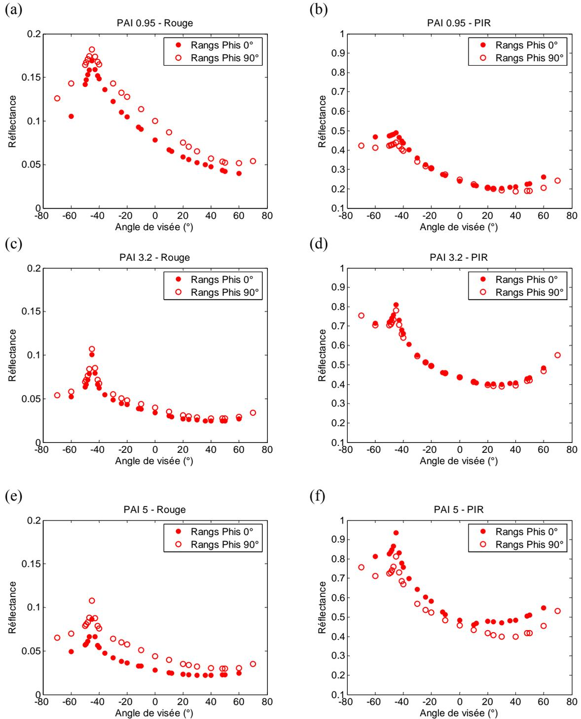
Figure IV-10: FDRB 3D dans le **plan principal** simulées pour un sol **limoneux anisotrope** pour les trois stades phénologiques et dans deux bandes spectrales : proche infrarouge (790-890 nm) et rouge (610-680nm).  $\theta_s=45^\circ$ .
