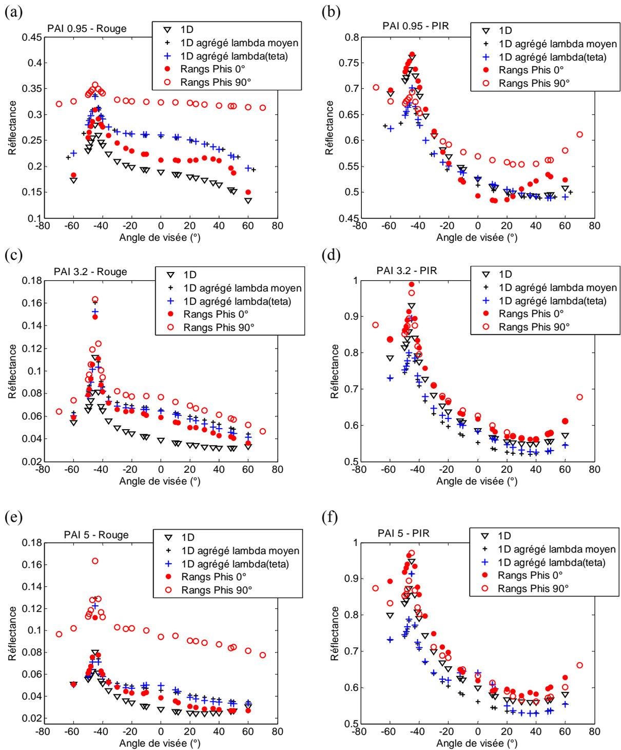
Figure IV-12: FDRB 3D, 1D, 1D agrégé ( $\lambda_{moyen}$  et  $\lambda(\theta)$ ) dans le **plan principal** simulées pour un sol **argileux lambertien** pour les trois stades phénologiques et dans deux bandes spectrales : proche infrarouge (790-890nm) et rouge (610-680nm).  $\theta_s = 45^\circ$ .
