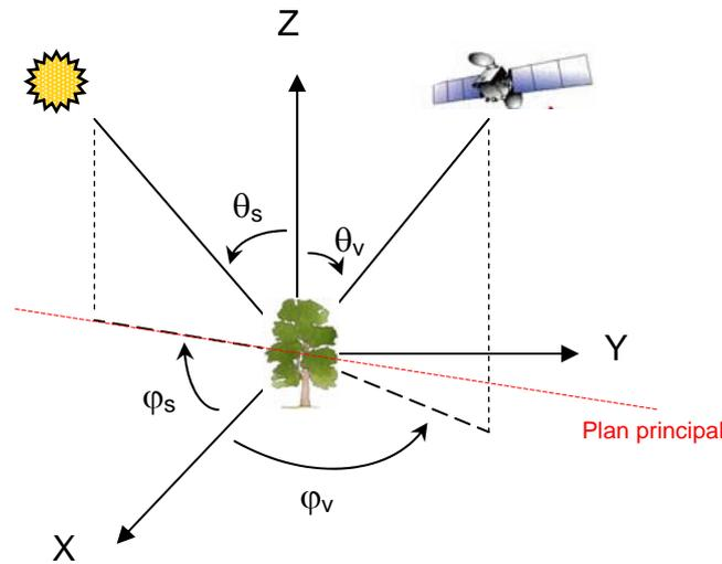
Figure I-1 : schéma indiquant la géométrie d'illumination et d'observation.
