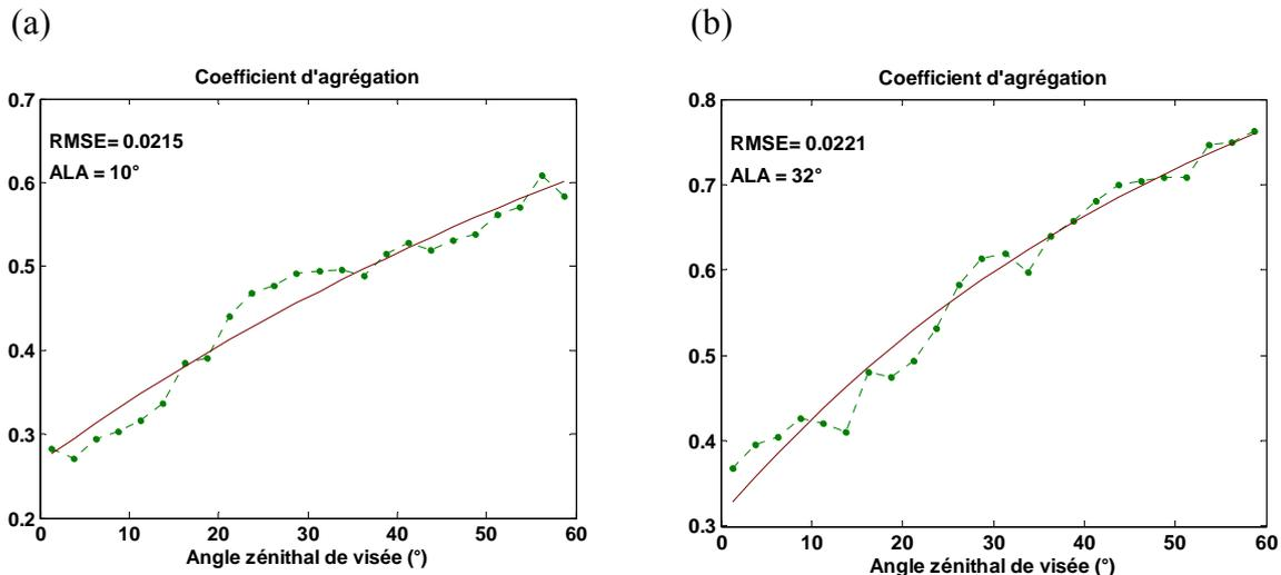
Figure III-10: Evolution du coefficient d'agrégation en fonction de l'angle zénithal de visée  $\theta_v$ . Courbe verte : coefficient d'agrégation  $\lambda$  calculé selon la méthode de Lang et Xiang (1986). Courbe rouge : loi  $\lambda(\theta_v)$  ajustée (Rochdi, 2003). (a) stade de tournesol le 7 juin et (b) stade de maïs le 6 juillet 2005.
