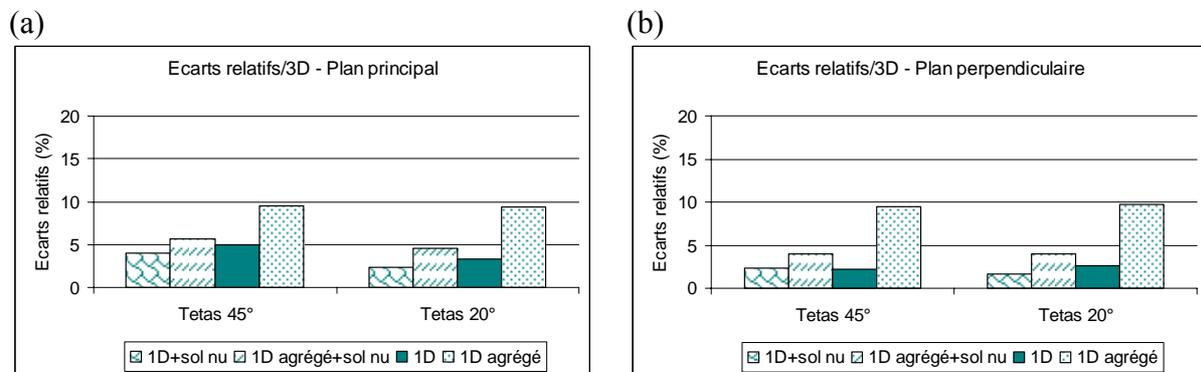
Figure V-8: Ecart relatif (en %) entre la FDRB simulée dans le proche infrarouge pour le paysage "culture+prairie+sol nu" et le paysage "1D+sol nu", "1D agrégé + sol nu", "1D" et "1D agrégé" pour les plans principal et perpendiculaire et deux angles zénithaux d'éclairage (20 et  $45^\circ$ ).
