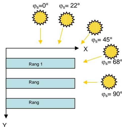
Figure IV-2: Directions azimutales par rapport à l'axe des rangées pour les maquettes3D construites avec DART ( $\varphi$  correspond à l'angle azimutal solaire).
