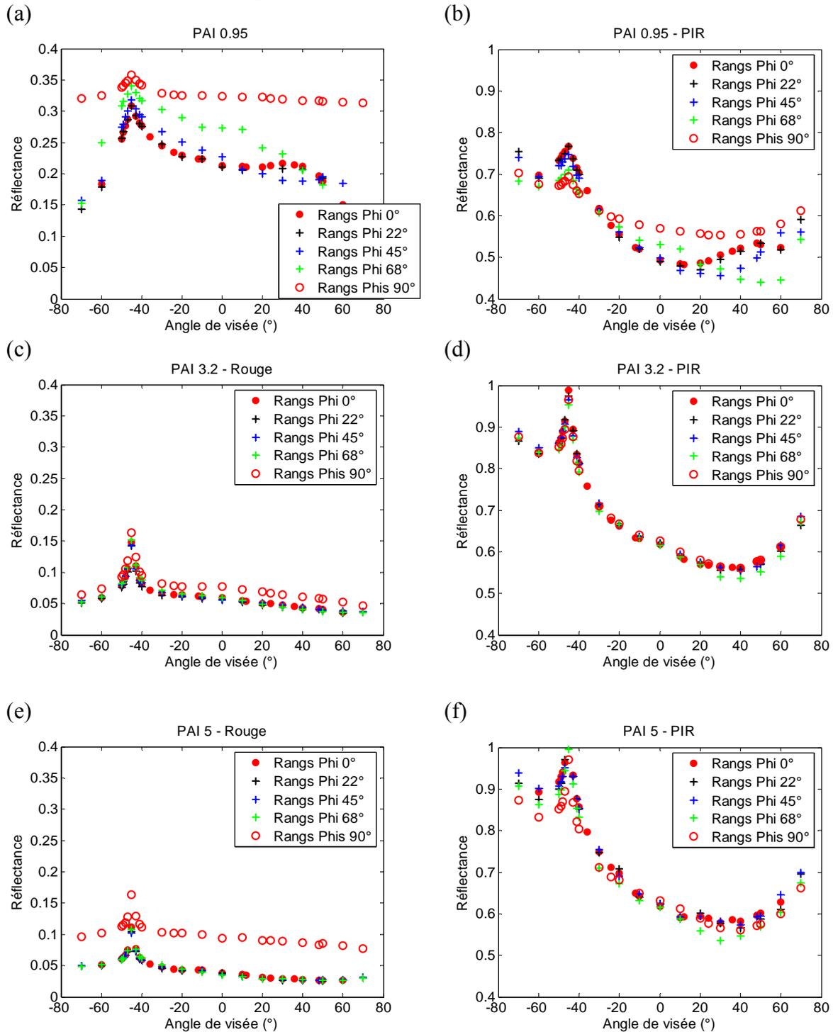
Figure A6-1: FDRB 3D dans le **plan principal** simulées pour un sol **argileux lambertien** pour les 3 stades phénologiques et dans deux bandes spectrales : proche Infrarouge (790-890 nm) et rouge (610-680nm).  $\theta_s = 45^\circ$ , tous les  $\phi_s$  sont représentés.
