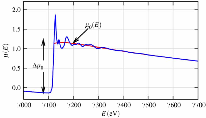
Figure AIII-6 : Soustraction de  $\mu_0(E)$  et normalisation
