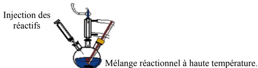
*Figure I-8 : Schéma de la procédure de synthèse de nanoparticules par la voie en solution à haute température.<sup>[28]</sup>*
