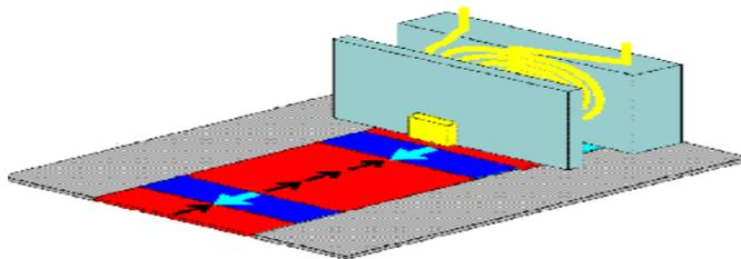
*Figure IV-1 : Schéma de principe d'une tête de lecture.*
