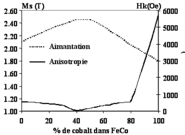
Figure I-4 : Evolution de l'aimantation à saturation et de l'anisotropie pour des alliages Fer / Cobalt en fonction du pourcentage de cobalt dans l'alliage.<sup>[6]</sup>
