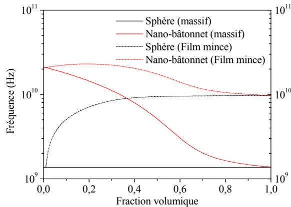
*Figure I- 7: évolution de la résonance ferromagnétique en fonction de la fraction volumique de nanoparticules pour des sphères et des nano-bâtonnets.<sup>[9]</sup>*
