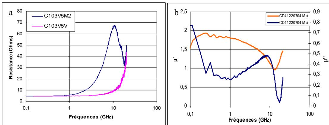
Figure IV-26 : a) Evolution de la résistance de l'inducteur en fonction de la fréquence avec (bleu) et sans (rose) matériau ; b) Evolution de  $\mu'$  (orange) et  $\mu''$  (bleu) en fonction de la fréquence.
