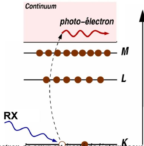
Figure AIII-2 : L'électron de cœur est éjecté de l'atome sous forme d'un photoélectron
