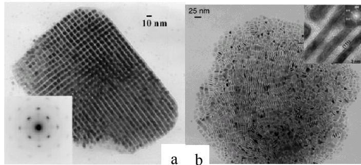
*Figure I-11 : Particules de fer et de nickel obtenues par la voie organométallique : a) nanocubes de fer<sup>[23]</sup> ; b) nano-bâtonnets de nickel.<sup>[53]</sup>*
