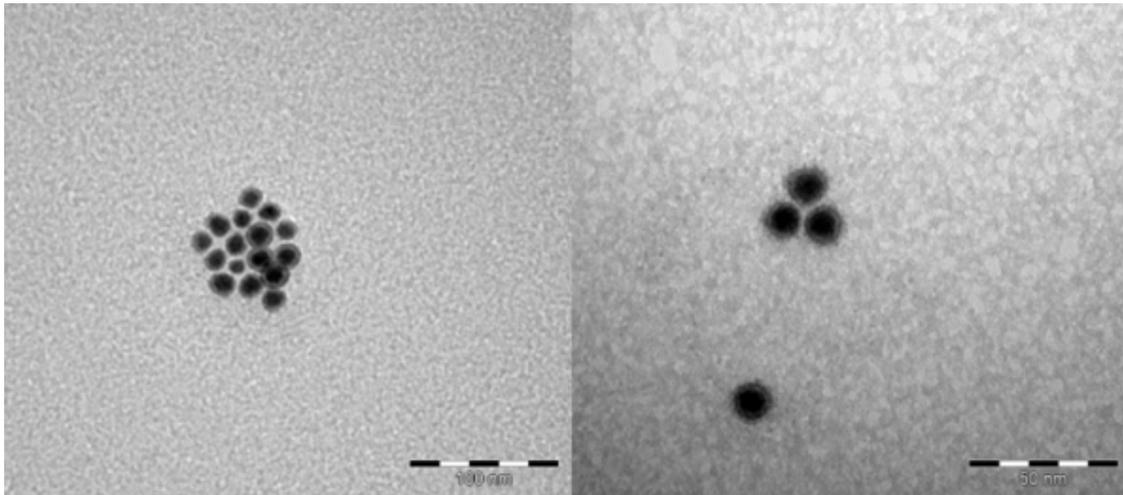
*Figure III-16 : Particules de FeCo enrobées de silice.*
