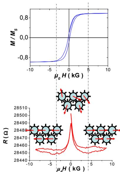
*FigureIV-18 : Magnétorésistance tunnel s'indexant parfaitement sur la courbe d'hystérésis du matériau mesuré.*
