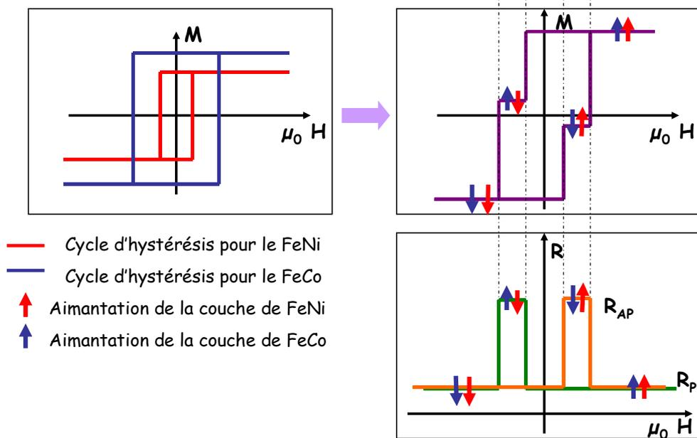
Figure IV-7 : Schématisation de la forme typique d'une TMR.
