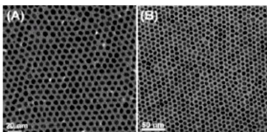
Figure I-12 : Nanoparticules de fer/platine : a) particules de 6 nm de  $\text{Fe}_{53}\text{Pt}_{47}$  ; b) particules de 9 nm de  $\text{Fe}_{44}\text{Pt}_{56}$ .<sup>[59]</sup>
