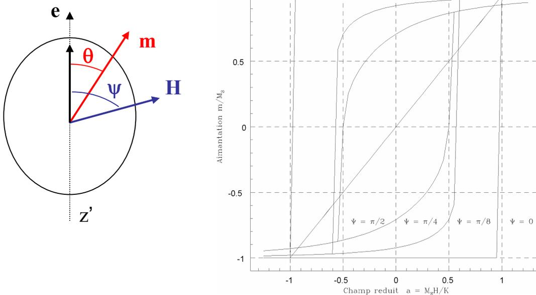
Figure 1-7 : Courbe d'hystérésis dans le modèle de Stoner-Wolfarth pour différentes orientations du champ magnétique par rapport à l'axe d'anisotropie
