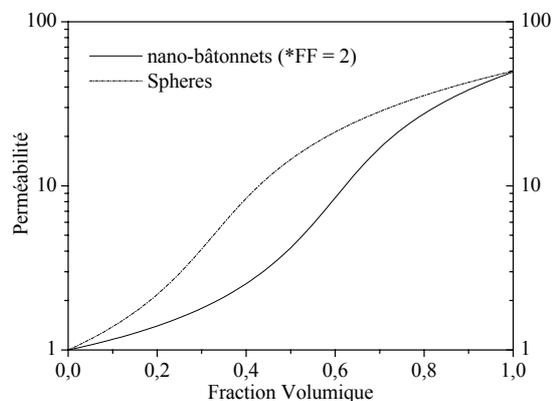
*Figure I- 6 : évolution de la perméabilité effective en fonction de la fraction volumique pour des sphères et pour des nano-bâtonnets selon l'approximation de Bruggeman.<sup>[9]</sup>*
