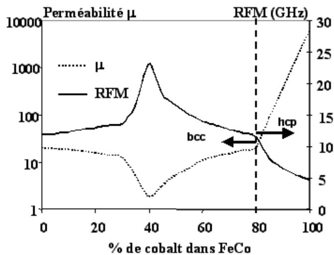
Figure I- 5: évolution de la perméabilité et de la résonance ferromagnétique en fonction de la composition d'un alliage fer / cobalt.<sup>[6]</sup>
