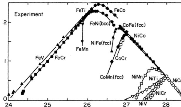
Figure I-3 : moment magnétique de l'alliage ( $\mu_B/at$ ) en fonction du nombre d'électrons par atome.<sup>[6]</sup>
