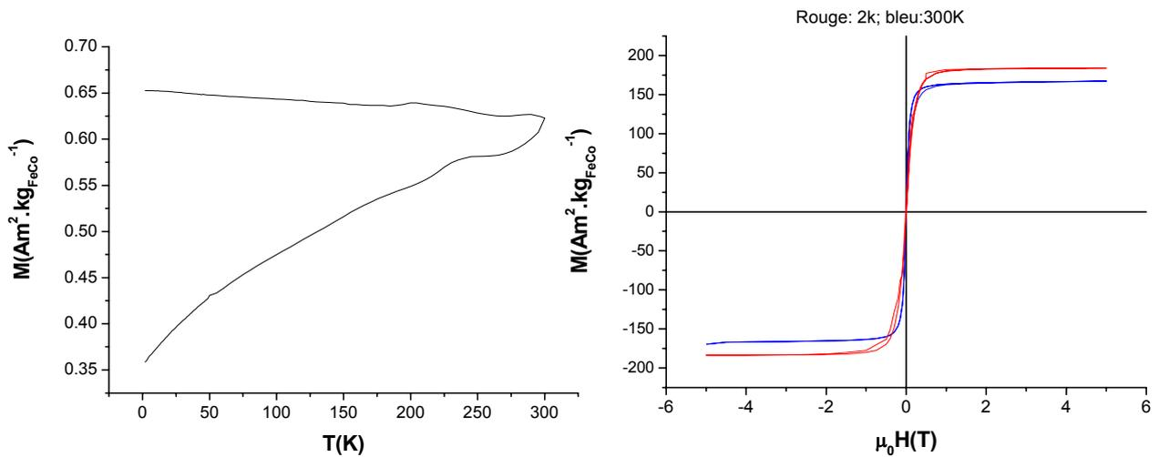
Figure II-5 : Propriétés magnétiques de NM2 : a) ZFC/FC ; b) hystérésis à 2K (rouge) et à 300K (bleu).
