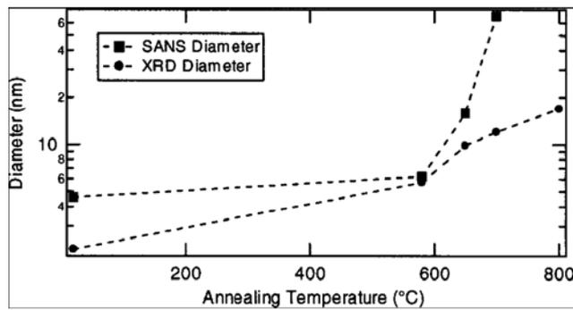
Fig. III-1 : Variation du diamètre des particules en fonction de la température de recuit.<sup>[2]</sup>
