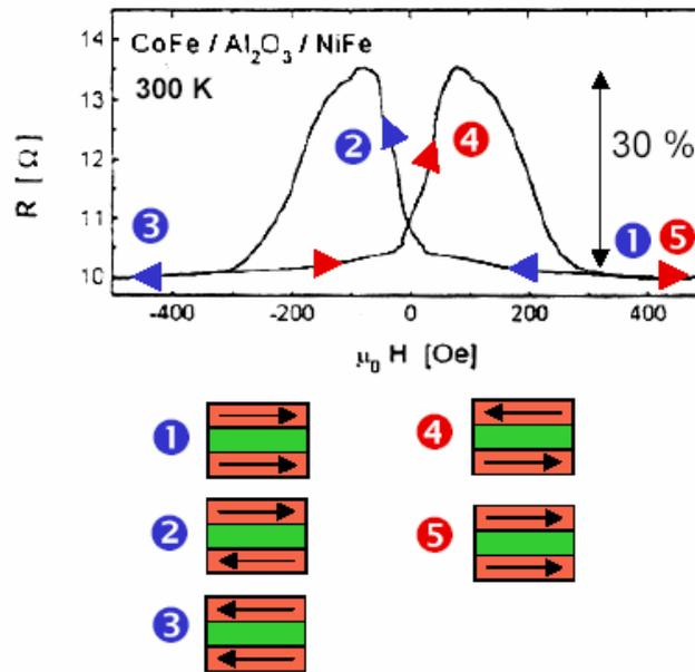
Figure IV-6 : Courbe expérimentale de la TMR dans un matériau  $\text{CoFe}/\text{Al}_2\text{O}_3/\text{NiFe}$ .
