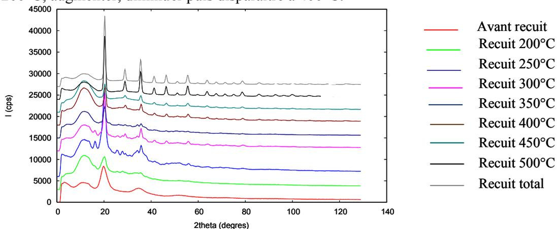
Figure III-6 : Diffractogrammes de NMI à différentes température de recuit.
