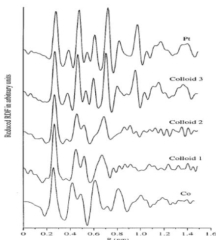
*Figure I-13 : Fonction de densité radiale expérimentale des différentes compositions de l'alliage CoPt obtenu. Colloïde 1 :  $\text{Co}_3\text{Pt}$  ; Colloïde 2 :  $\text{CoPt}$  ; Colloïde 3 :  $\text{CoPt}_3$ .<sup>[66]</sup>*
