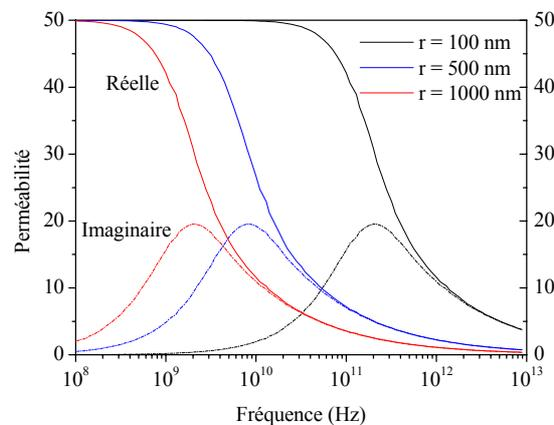
Figure I- 2 : Evolution de la perméabilité en fonction de la fréquence.<sup>[6]</sup>
