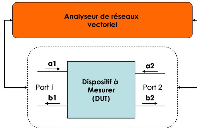
*Figure IV-20 : Principe de la mesure des paramètres S.*
