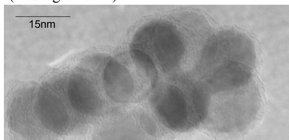
Figure III-3 : Cliché HRTEM des particules recuites.
