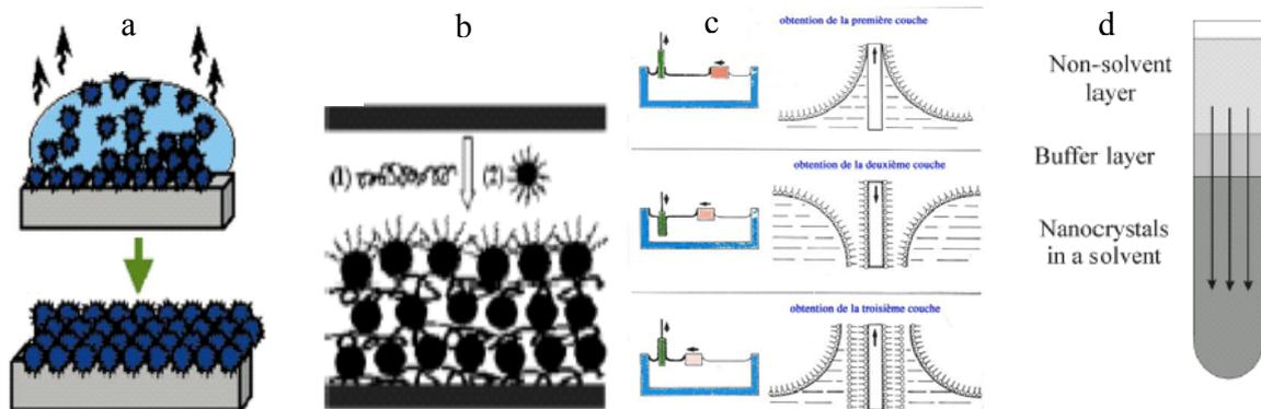
Figure I-14 : Les différentes techniques d'organisation des particules : a) évaporation de solvant sur un substrat ;<sup>[26]</sup> b) assemblée dirigée par un polymère ;<sup>[105]</sup> c) technique de Langmuir-Blodgett ; d) technique de saturation contrôlée de la solution.<sup>[109]</sup>
