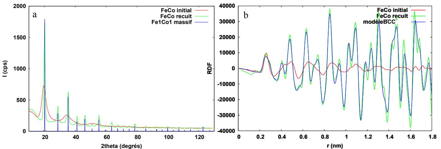
*Figure III-5 : Etude WAXS de NM1 avant recuit (rouge), après recuit (vert) et tables ou calcul (bleu) : a) diffractogramme ; b) RDF.*
