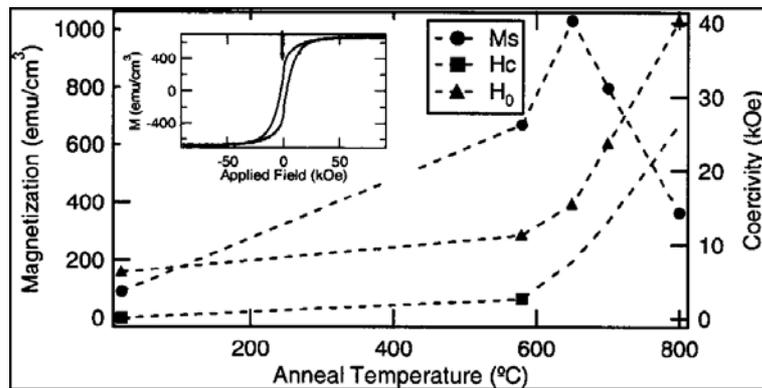
Fig.III-2 : Variation du champ coercitif ( $H_c$ ), de l'aimantation à saturation ( $M_s$ ) et du champ rémanent ( $H_0$ ) en fonction de la température de recuit.<sup>[4]</sup>
