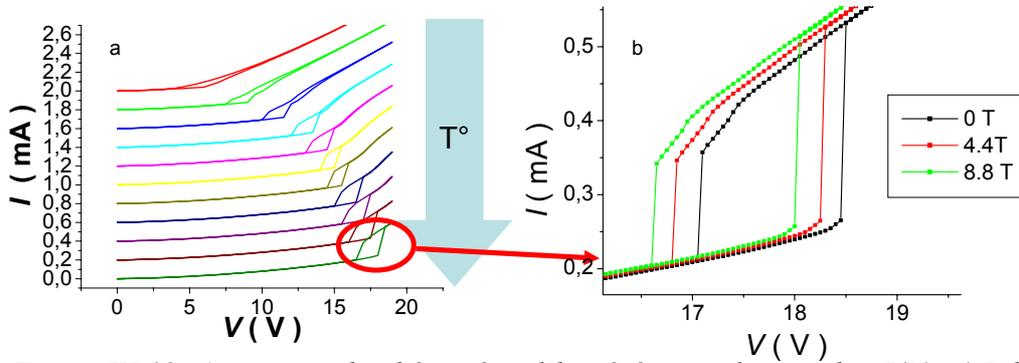
Figure IV-19: Apparition du phénomène d'hystérésis sur les courbes  $I(V)$ . a) L'hystérésis se décale vers la droite lorsque  $T$  diminue ; b) Décalage de l'hystérésis vers la gauche lorsque le champ magnétique augmente.
