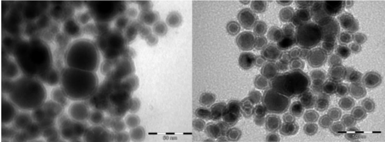
Figure III-17 : Coalescence des particules après 10 jours en solution.
