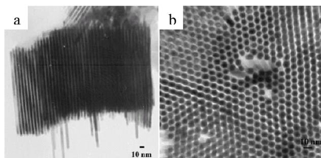
*Figure I-10 : Clichés de microscopie de nano-bâtonnets de cobalt obtenus par la voie organométallique : a) vue de profil : b) vue sur la tranche.<sup>[40]</sup>*
