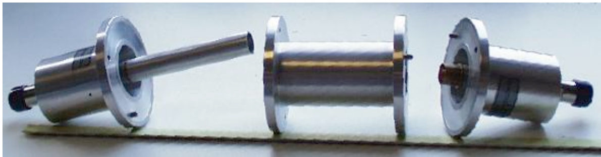
Figure 5-22 : Photographie du porte échantillon : conducteurs interne et externe (cellule commercialisée par Damaskos Inc.)
