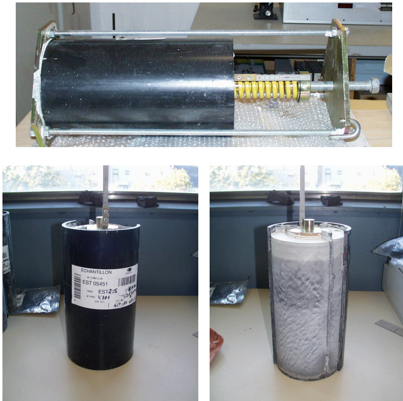
Figure 7-3 : Photographies d'une cellule T1 protégeant une carotte d'argilite provenant du forage EST205, et de son ouverture. Les carottes sont placées dans une gaine de plastique et mises sous contrainte par des ressorts. L'ensemble carotte/gaine est coulé dans du ciment.
