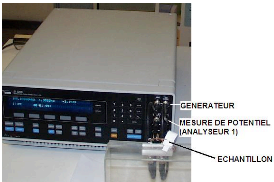
Figure 5-29 : Photographie d'un analyseur d'impédance/gain-phase Solartron 1260 ; une mesure à deux électrodes est réalisée.
