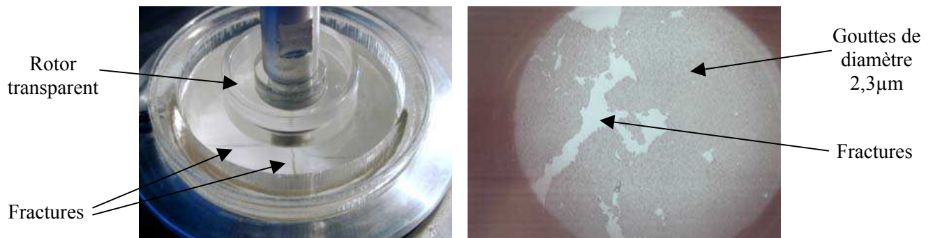
Figure 4.17: Images de fracture macroscopiques et microscopiques pour des échantillons où la flocculation est provoquée par déplétion (à gauche) et par adhésion (à droite).
