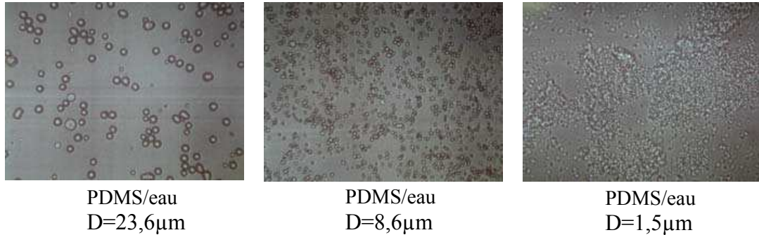
Figure 3.18: Observation en microscopie optique des émulsions utilisées pour mesurer \Pi(\phi) .
