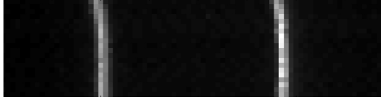
Figure 7.3 – Image ( 40\ \mu\text{m} \times 10\ \mu\text{m} ) obtenue avec un microscope actinique en champ sombre dans le cas d'un défaut linéique enterré de 19,4 nm de hauteur et d'une largeur de 20\ \mu\text{m}
