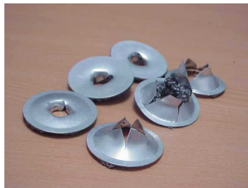
FIGURE 3.27: Photographies de post-perforation dynamique de la plaque incidente (les 3 peaux à gauche) et de plaque secondaire (les 3 peaux à droite).
