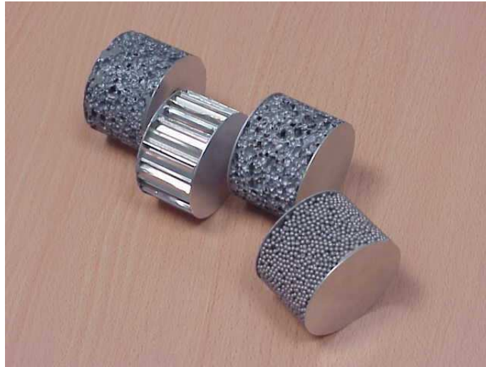
FIGURE 3.10: Photographies des sandwichs testés. De gauche à droite : âmes à base de mousse Cymat, nid d'abeille, mousse Alporas et sphères creuses en nickel.
