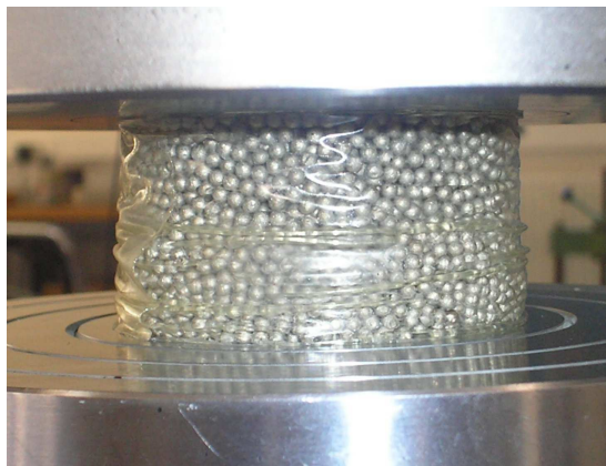
FIGURE 2.15: Photographie d'essai de confinement de sphères creuses.
