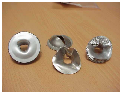
FIGURE 3.38: Photographie des sandwichs perforés en dynamique. Sandwich à base mousse Alporas (gauche), sphères creuses (milieu) et nid d'abeille (droite).
