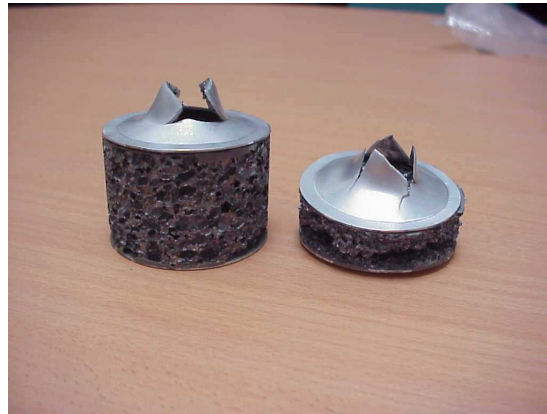
FIGURE 3.26: Photographies de post-perforation du sandwich : quasi-statique (à gauche) et dynamique (à droite).
