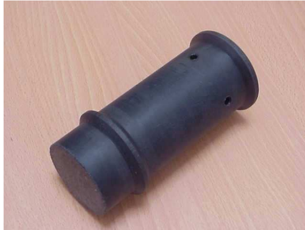
FIGURE 2.11: Photographie de projectile conçu pour réaliser des essais à très grande vitesse (Masse=0.412 Kg, L=150 mm, \phi = 60 mm).
