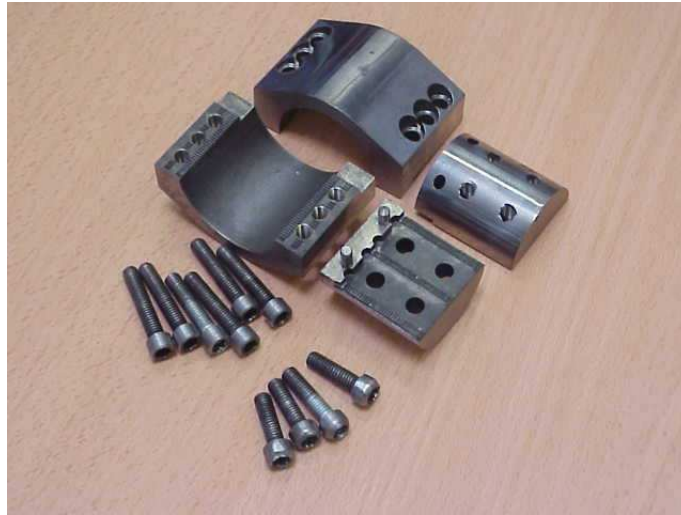
FIGURE 3.13: Photographies de montage pour cisaillement double de tôles (Merle [2006]).
