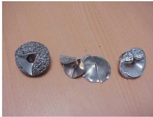
FIGURE 3.37: Photographie des sandwichs perforés en quasi-statique. Sandwich à base mousse Alporas( gauche), sphères creuses (milieu) et nid d'abeille (droite).
