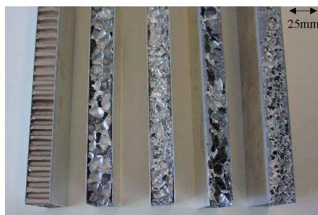
FIGURE 3.22: Photographie des sandwichs utilisés, dimensions 100 \times 500 \text{ mm} (d'après Salvo [2004]).
