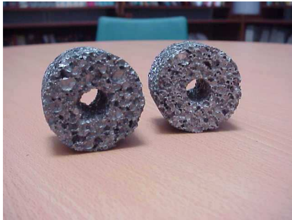
FIGURE 3.31: Photographie des mousses perforées en quasi-statique.
