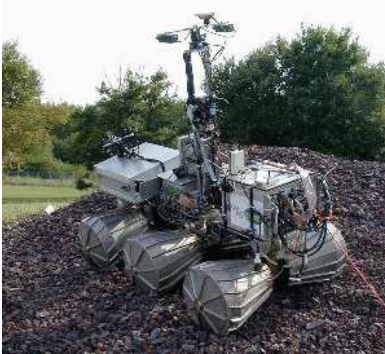
FIG. 2.4 – Banc stéréo monté sur le robot LAMA
