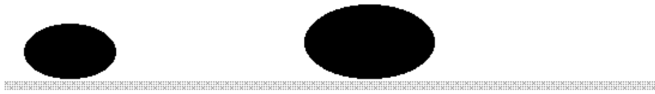
FIG. 6.6 – Schématisation 2D d'un des comportements biaisés de l'algorithme CMFE : plusieurs obstacles émergeant d'une large zone de sol sont rassemblés dans le même groupement
