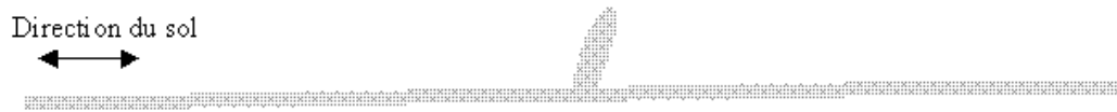
FIG. 6.12 – Schématisation 2D d'un des comportements biaisés de l'algorithme CMFE : un obstacle petit ou peu dense est associé à une large zone de sol
