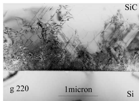
Figure III-8 : Microscopie électronique en transmission en coupe transverse d'une couche épitaxiale de 3C-SiC sur Si(100).
