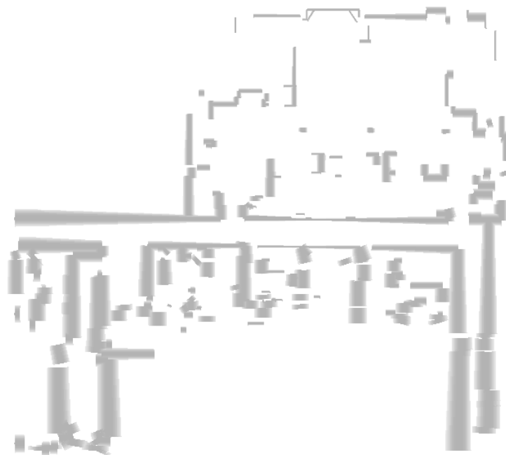
FIG. III.10 – Grille d'occupation obtenue à partir d'une carte de segments, les incertitudes sur les segments sont représentées : plus la couleur va vers le gris clair et plus la probabilité d'occupation est faible.
