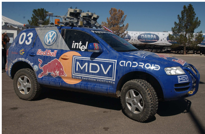
FIG. II.8 – Le véhicule “Stanley” de Stanford qui a remporté le grand challenge en 2005.
