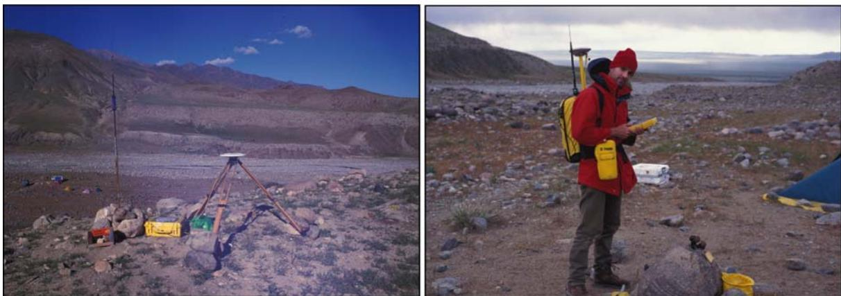
*Figure II.4 : Photos du dispositif du GPS cinématique, formé par deux récepteurs : une base (à gauche) et un mobile (à droite).*
