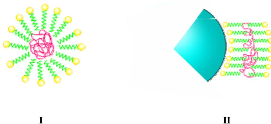
**Figure 17 :** Représentation schématique de la formation de chaînes polymères au sein **I)** de micelles, **II)** de molécules de tensioactif organisées en bicouche à la surface d'une particule minérale.
