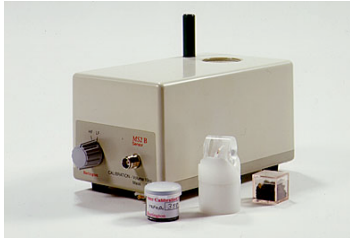
Figure III.14: Susceptomètre Bartington MS2B qui présente deux fréquences de mesure (0,465 kHz \pm 1% et 4,65 kHz \pm 1%) pour un champ faible maximum de 250 \mu T \pm 10% ( www.bartington.com ).
