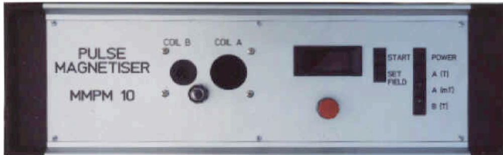
Figure III.23: L'implanteur d'aimantation sous champ fort MMPM10. Col A pour les échantillons de 1 pouce de diamètre; Col B: pour les échantillons de quelques millimètres de diamètre ( www.magnetic-measurements.com ).
