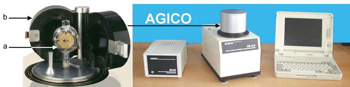
Figure III.19: Magnétomètre JR5-A et son porte échantillon (a), dans le boîtier contenant les bobines de mesure (b).
