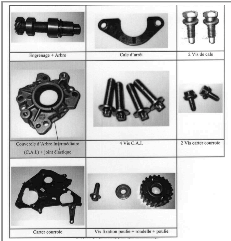
Figure n°41 : Les différents composants du système étudié
