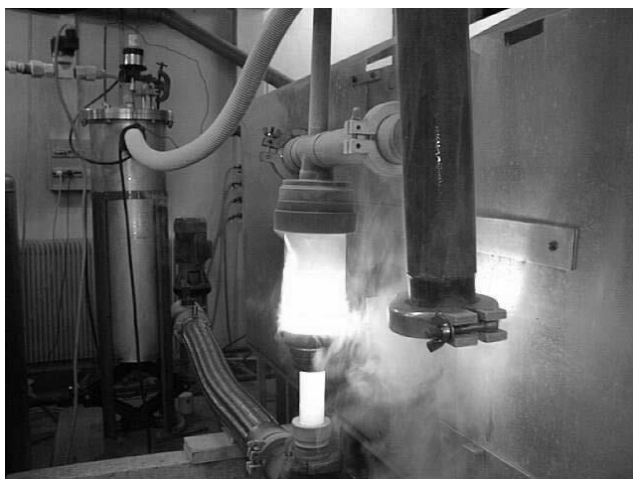
FIG. 11.1: Vue du réacteur de fusion en milieu cryogénique (brevet CECM). Le métal en surfusion est maintenu en lévitation magnétique dans l'azote liquide
