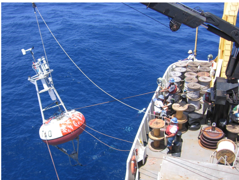
Figure 2.1 – Déploiement d'une bouée TAO depuis le navire Ka'imimoana. Il s'agit d'une bouée un peu particulière puisqu'elle effectue également des mesures de p\text{CO}_2 (les bouées "classiques" sont toriques, sans instruments au centre).
