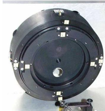
FIG. 7.2 – MAD corrige la turbulence grâce à deux miroirs déformables bimorphes (fig. a). Celui qui est conjugué à la pupille est monté sur une monture tip/tilt (fig. b). (Crédits : ESO)
