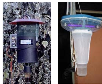
Figure 12 : Les 2 types de pièges UV à succion utilisés pour la capture des Culicoides en France
