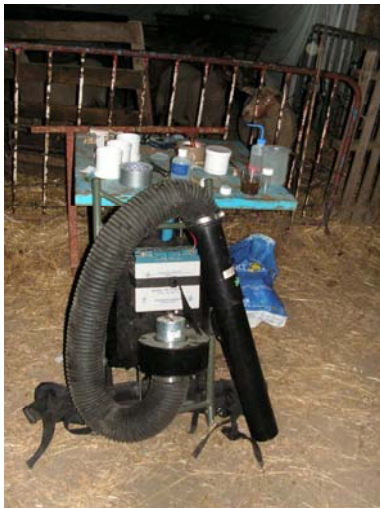
Photo 5 : Aspirateur dorsal à batterie de type CDC et adapté pour la capture des Culicoides
