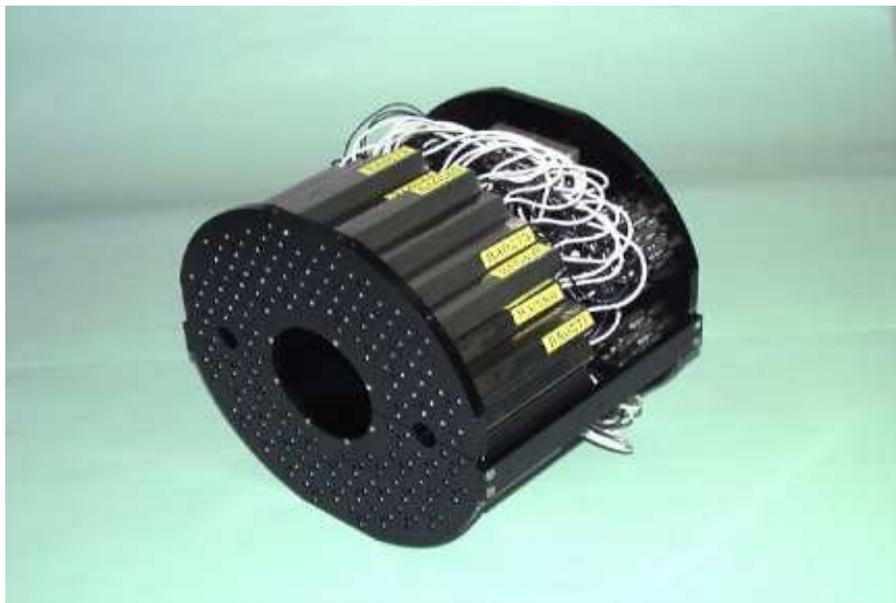
FIG. 2.10 – Vue de l'un des BBC constitué de 64 éléments photomultiplicateurs.
