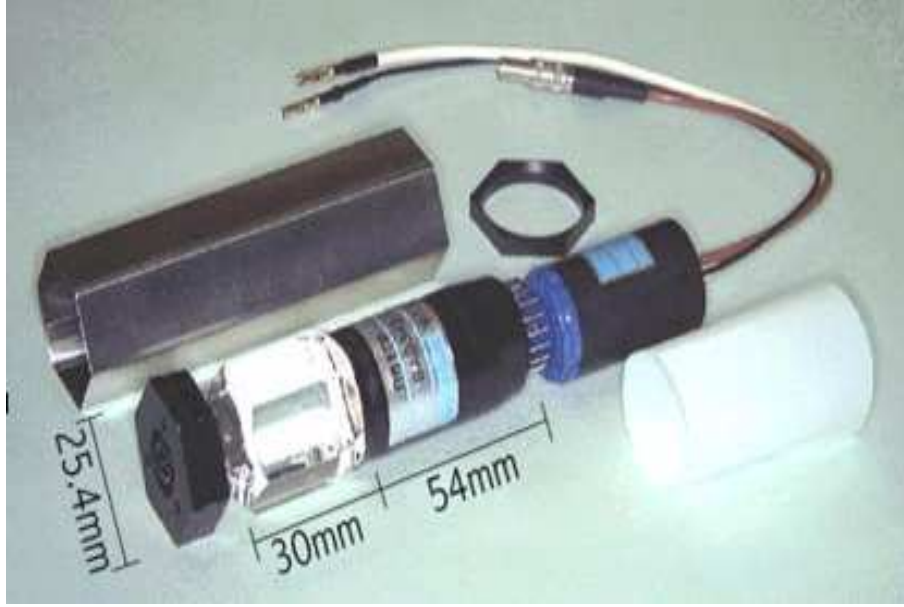
FIG. 2.11 – Vue de l'un des tubes photomultiplicateurs du BBC associés à un quartz hexagonal.
