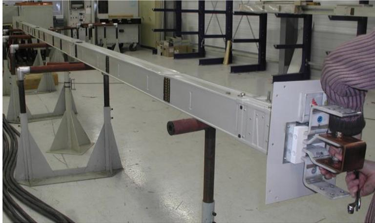
FIG. 4.37 – Banc d'essai de la canalisation KSA 80, constitué de l'assemblage de 3 tronçons de 3 mètres
