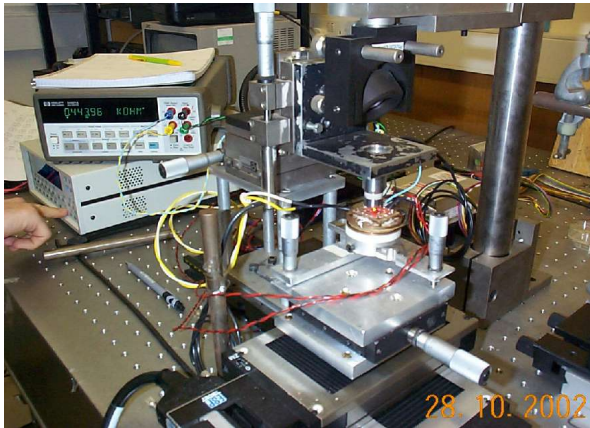
Figure III-21: Photographie de l'échantillon testé sur son porte-échantillon chauffant et sous la lentille de focalisation (univ. Bath).
