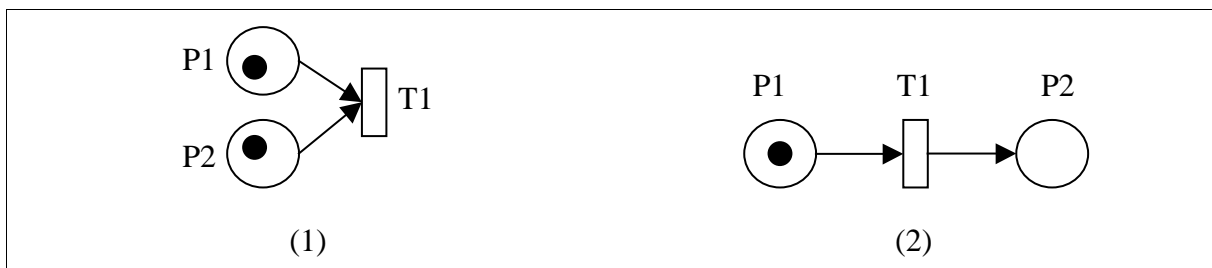
Figure 69. Synchronisation et précedence dans un RdP
