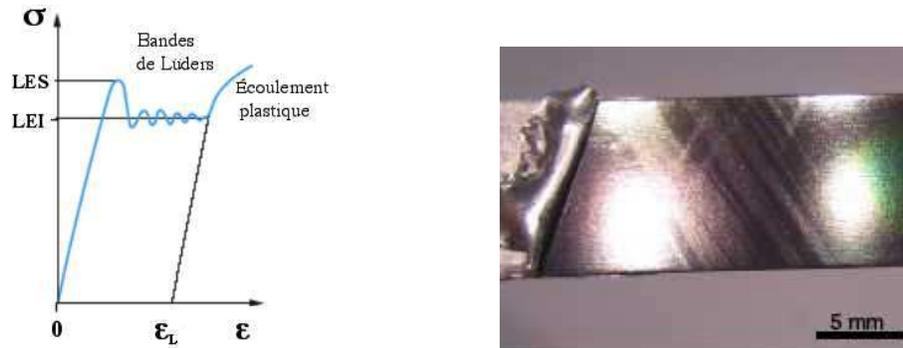
FIG. 2.15: (a) Caractéristique charge-déformation avec le palier d'écoulement discontinu dû aux présences des bandes Piober-Lüders dans certains aciers mous. (b) Image optique des bandes de Lüders observés dans les rubans de Hastelloy C276 par Sugano [3].
