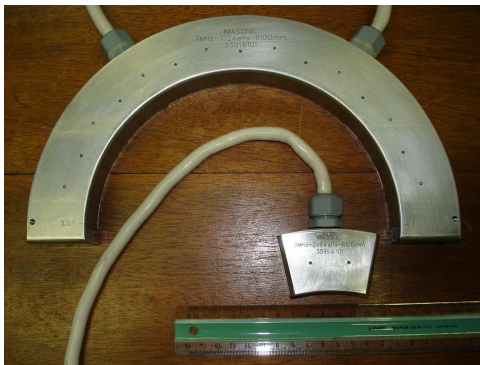
(a) Antenne semi-circulaire finale 1024 éléments et maquette-test 128 éléments.
