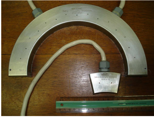
FIG. 13 – Antenne semi-circulaire de 1024 éléments de fréquence centrale 3 MHz et maquette-test de 128 éléments.
