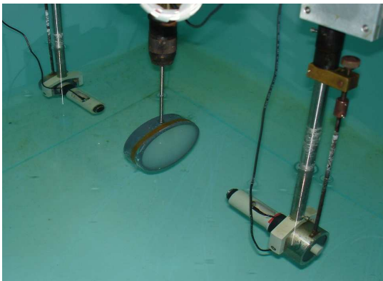
FIG. 7.6 – Position relative de l'échantillon d'agar-agar et des transducteurs. Les deux transducteurs ultrasonores sont montés coaxialement de part et d'autre de l'échantillon.
