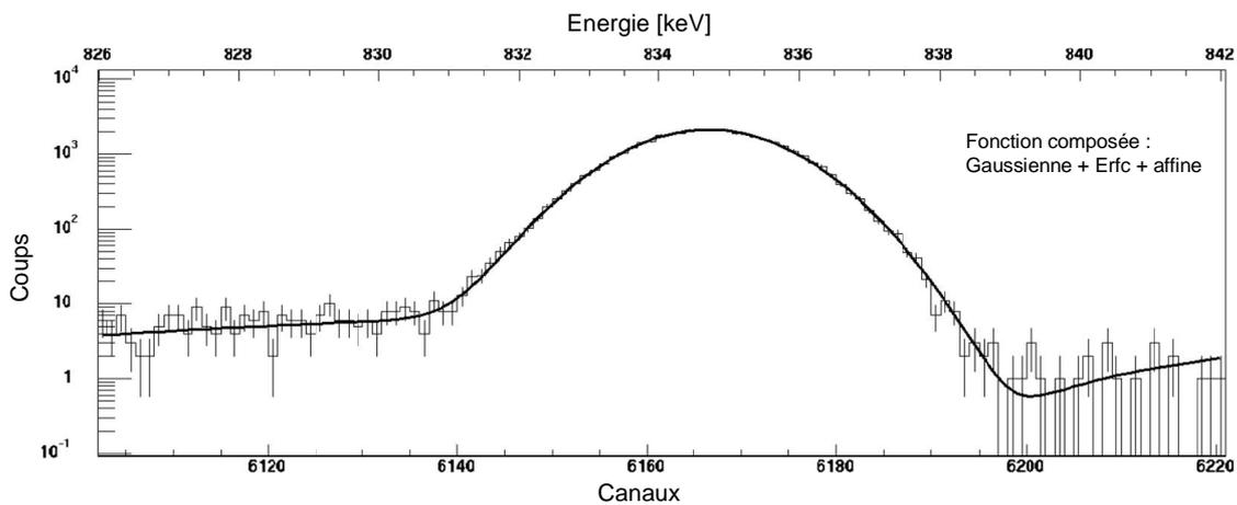
FIG. 3.11 – Ajustement de la raie de  $^{54}\text{Mn}$  avec une fonction composée d'une Gaussienne centrée à 834 keV, d'une fonction erreur inverse et d'une fonction affine. Le rapport  $\chi^2/\text{nof} = 92,8/104$  vaut 0,89.
