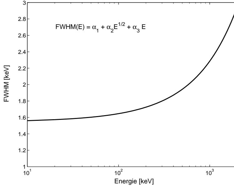
FIG. 3.13 – Résolution spectrale ( $FWHM$ ) du plan de détection en fonction de l'énergie à 90 K
