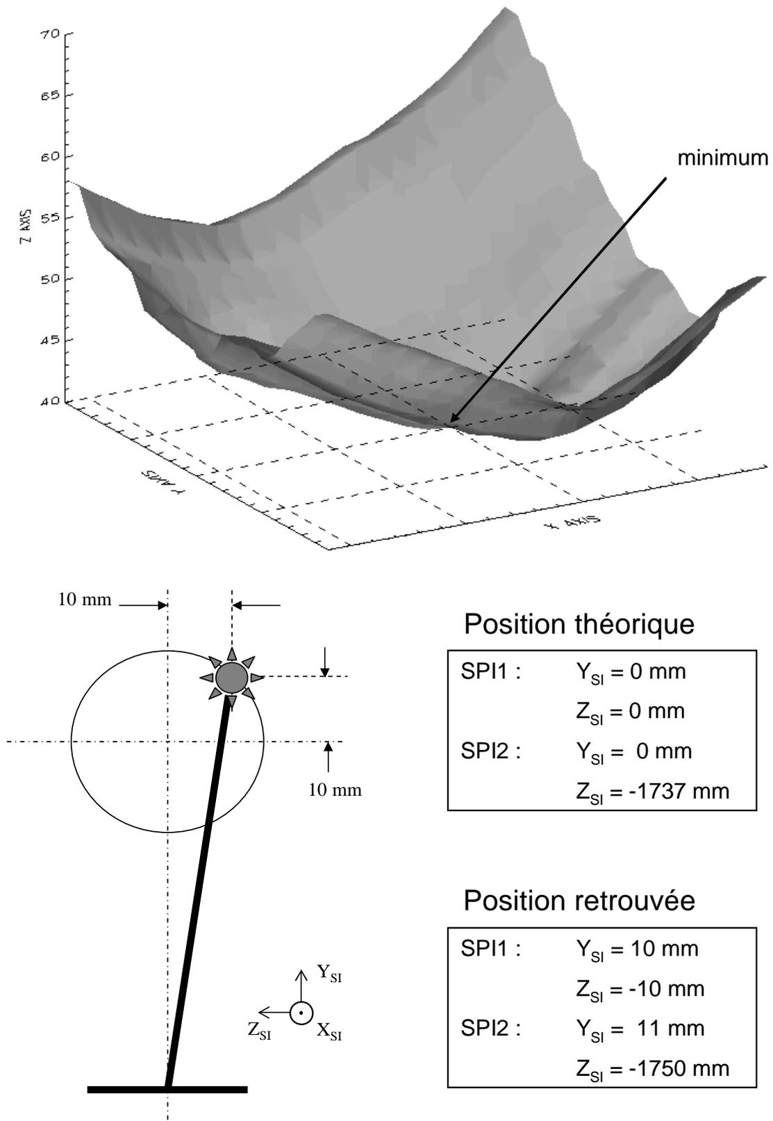
FIG. 3.18 – Recherche de la position du support de sources à courtes distances.
