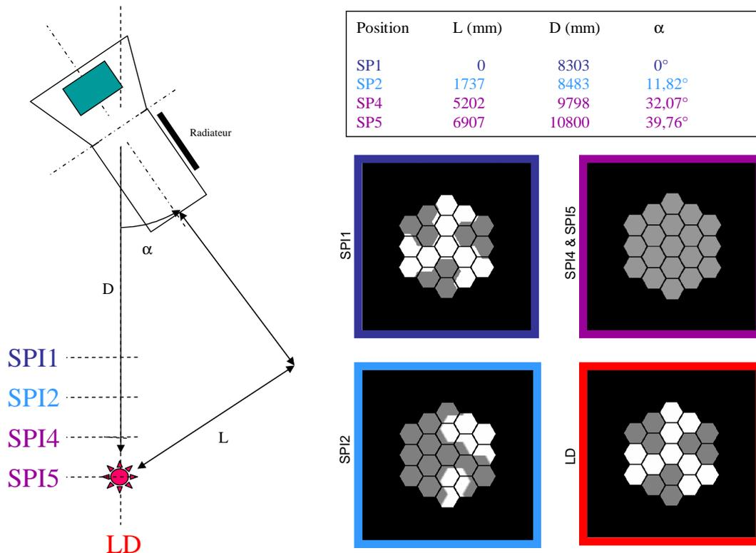
FIG. 3.4 – Simulation des projections sur le plan détecteur de SPI pour une source à différentes positions. La couleur blanche correspond à l'éclairement du rayonnement  $\gamma$  à travers des trous du masque.
