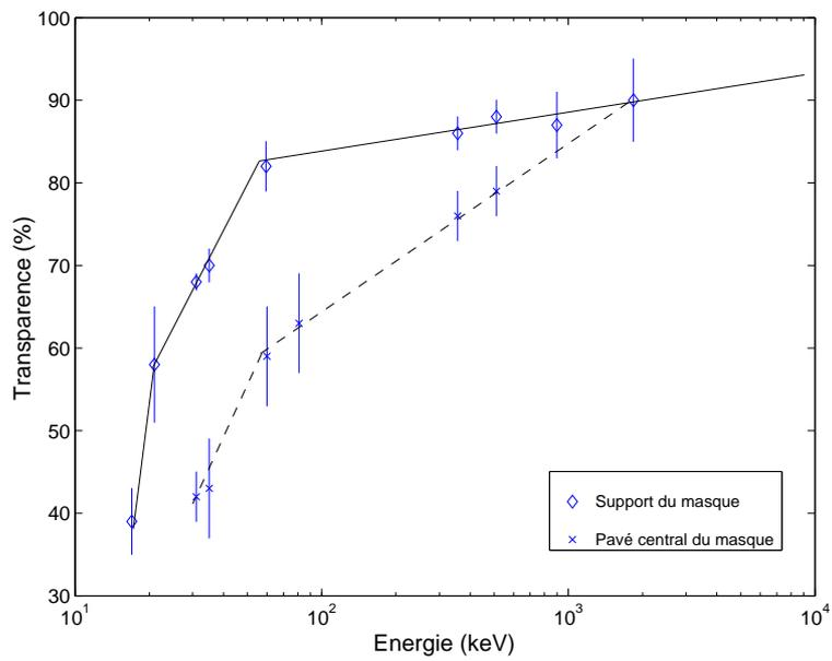
FIG. A.3 – *Transparence mesurée du masque de SPI.*
