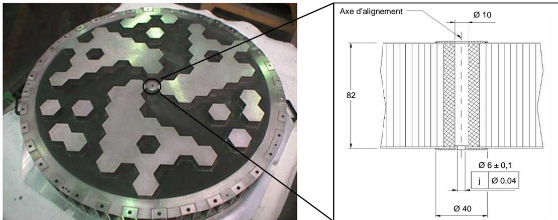
FIG. 3.21 – Schéma du trou dans le masque utilisé pour l'alignement du plan de détection. Les matériaux utilisés pour le renforcement de ce trou entraînent une absorption supplémentaire du rayonnement qui atteint les détecteurs positionnés en dessous de celui-ci.
