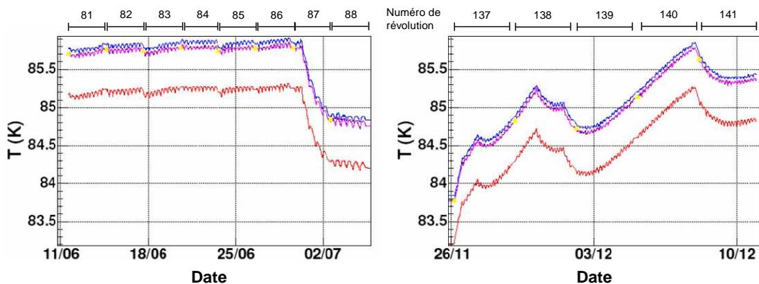
FIG. 6.9 – Variation des quatre sondes de température proches des détecteurs pendant les deux campagnes d'observation de la région des Voiles.
