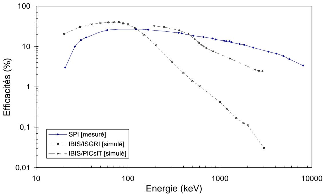
FIG. 3.28 – Efficacités comparées dans le pic photoélectrique de SPI (déduite des étalonnages) et d'IBIS (simulés), d'après [Lebrun et al. \(2003\)](#) pour ISGRI et [Bird et al. \(2003\)](#) pour PICsIT.
