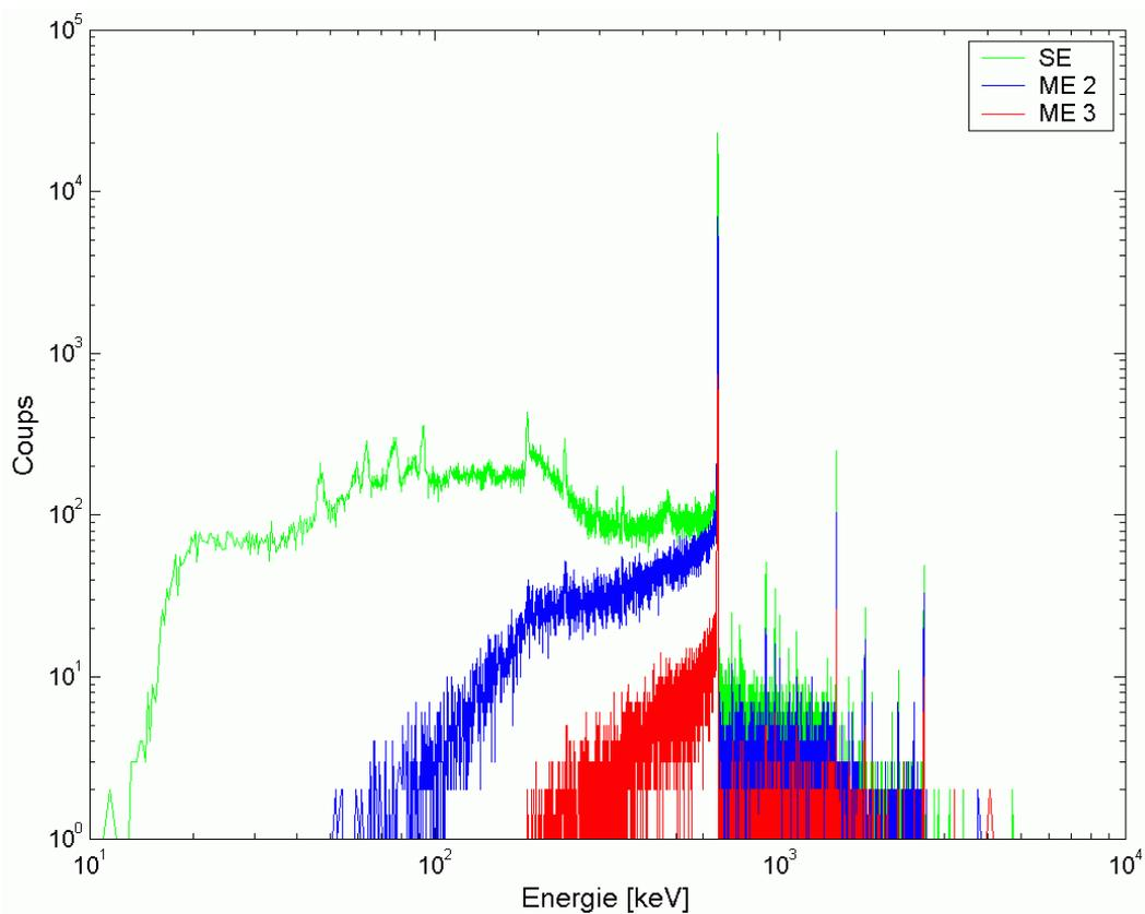
FIG. 3.9 – Spectre SE et ME (ME2 : évènements doubles ; ME3 : évènements triples) d'une source de  $^{137}\text{Cs}$  enregistré pendant la mesure (RUN) 65 de la campagne d'étalonnage à Bruyères-le-Châtel.
