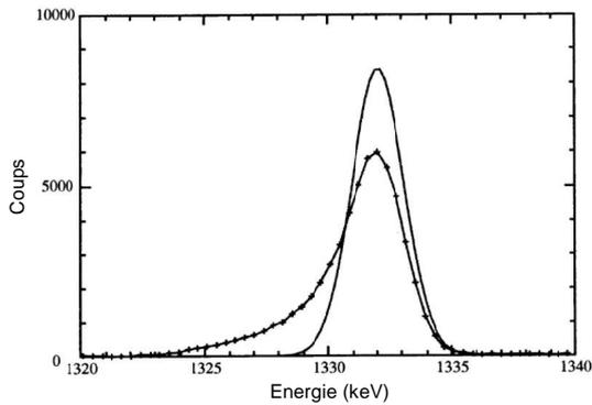
FIG. 4.11 – Dégradation de la résolution d'une raie à 1333 keV d'une source de  $^{60}\text{Co}$  après irradiation par des neutrons (pointillé) comparée à une raie idéale (gaussienne en trait plein), la résolution varie de 3,45 keV à 5,24 keV (d'après Leloux et al., 2003).
