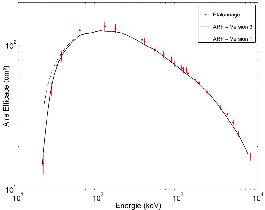
FIG. 3.32 – Aire efficace simulée du spectromètre SPI après le lancement (ARF - Version 3) comparée à la réponse simulée au sol (ARF - Version 1) ainsi qu'à celle déduite des mesures d'étalonnage.
