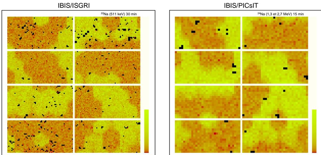
FIG. 3.27 – Projection du masque de SPI sur le plan de détection d'IBIS. [À gauche] image du plan de détection d'ISGRI avec une source de  $^{22}\text{Na}$  (511 keV) positionnée en IBIS4 pendant environ 30 min et [à droite] image du plan de détection de PICsIT avec une source de  $^{22}\text{Na}$  (1,3 et 2,7 MeV) enregistrée pendant 15 min.
