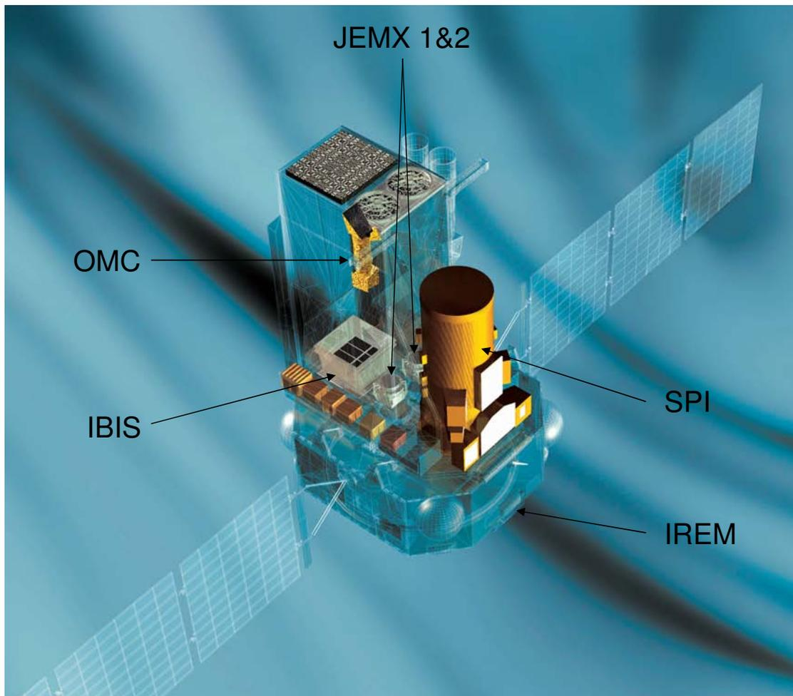
FIG. 2.4 – Les différents instruments à bord du satellite INTEGRAL
