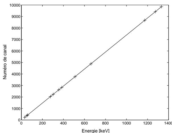
FIG. 3.12 – Courbe d'étalonnage en énergie du détecteur 1 du spectromètre ajustée par une fonction du type  $F = a \log E + b + cE + dE^2 + eE^3$  avec laquelle le meilleur  $\chi^2$  est obtenu. Cependant, une simple fonction affine est en général suffisante.
