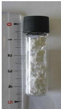
Figure IV.15 : Lot de 200mg de la mousse de couleur blanche obtenu avec un support en alumine et en présence d'un mélange de polypropylène et de carbone amorphe.
