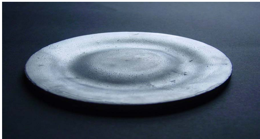
Figure 7.1. Photo montrant l'usure non uniforme d'une cible utilisée dans une configuration magnétron circulaire.
