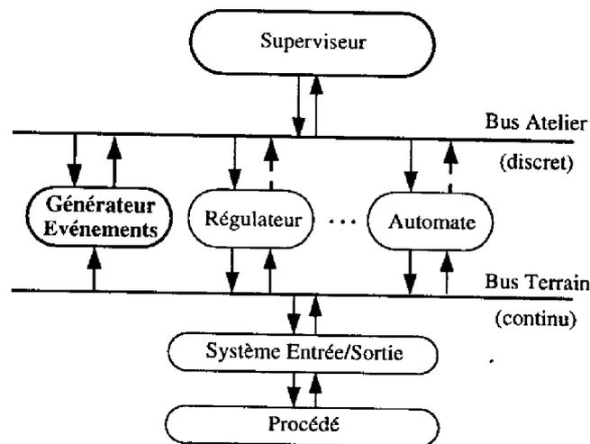
FIG. 4.9 – Position du générateur d'événements dans l'architecture informatique
