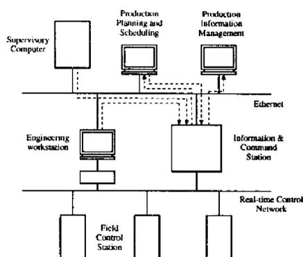
FIG. 2.7 – Architecture d'un système industriel (source Yokogawa)
