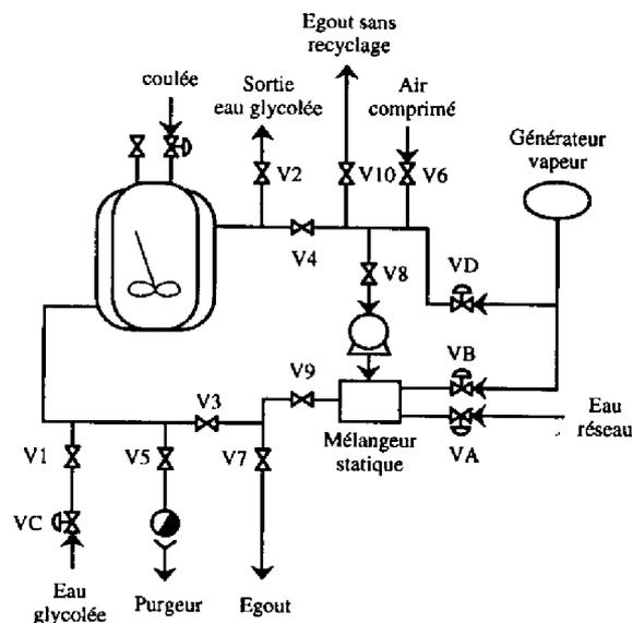
FIG. 1.2 – Le réacteur batch multifluide considéré
