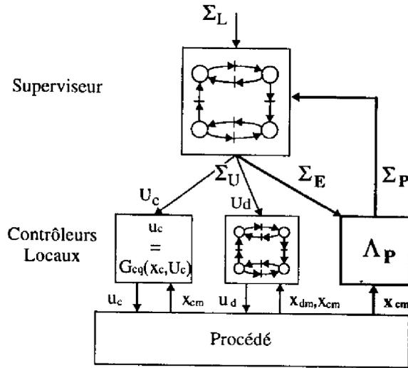
FIG. 4.10 – Supervision en boucle fermée
