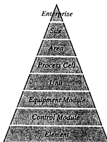
FIG. 2.1 – Les différents niveaux d'équipement (source ISA-dS88)
