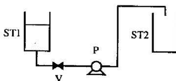
FIG. 4.8 – Exemple de deux réservoirs connectés en série
