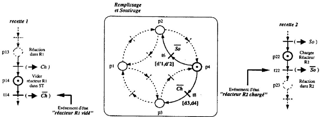
5.6.2: Réservoir connecté aux réacteurs  $R_1$  et  $R_2$
