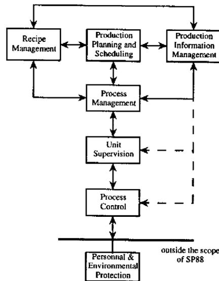
FIG. 2.3 – Les différents niveaux fonctionnels (source ISA-dS88)
