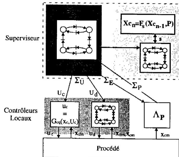
FIG. 5.12 – Supervision basée sur un modèle hybride
