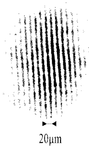
fig. 3 : Image de la figure d'interférence pour la configuration dégénérée, les niveaux de gris traduisent l'énergie lumineuse dont le maximum est ici en noir.
