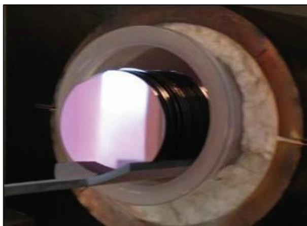
Figure 2-1 - Wafers à la sortie du four d'oxydation.
